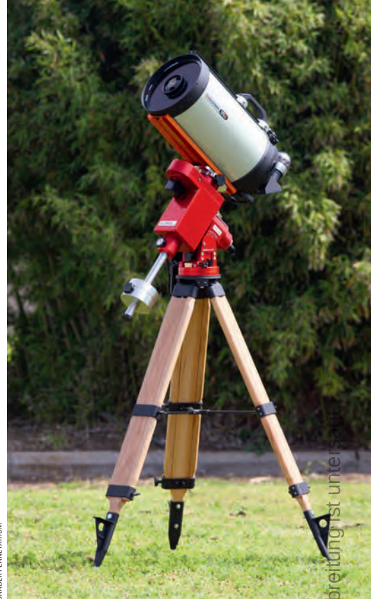
▲ Abb. 2: In der LineAR-Montierung von Avalon ist der Antrieb über Präzisions-Zahnriemen realisiert.
