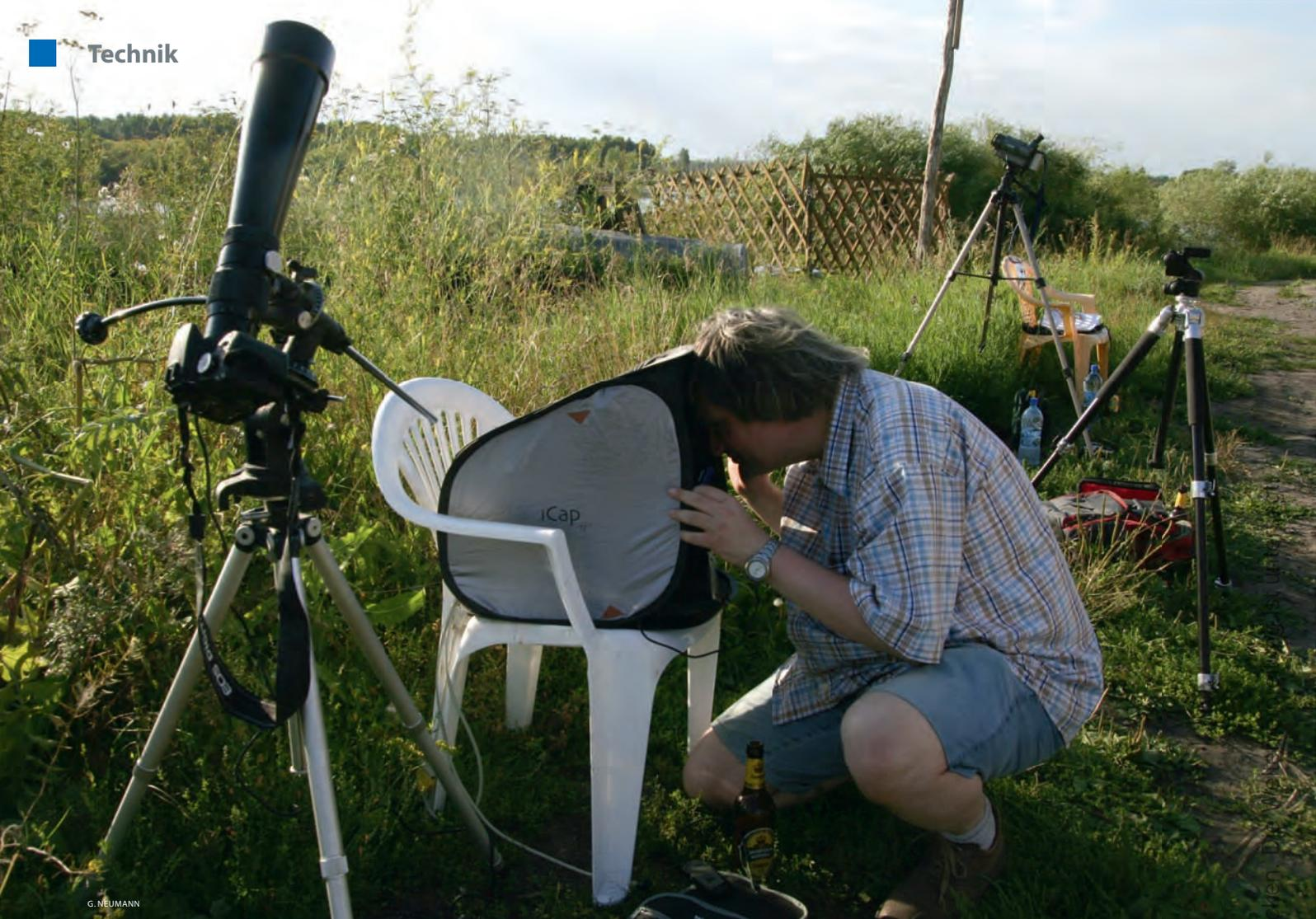
▲ Abb. 3: **Es wird ernst in Sibirien!** Blick auf den Aufbau des Verfassers wenige Minuten vor der Totalität der Sonnenfinsternis am 1.8.2008. Ein 500mm-f/6,3-Linsenteleobjektiv ist auf einer EQ2-Montierung aufgebaut und wird über einen Pulsmotor nachgeführt. Das Notebook im iCap-Zelt steuert via Eclipse Orchestrator eine Canon EOS 350D DSLR-Kamera.
