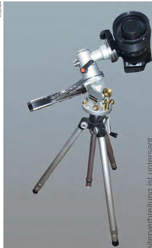
▲ Abb. 2: **Einige moderne Reisemontierungen** wiegen nur wenige Kilogramm, führen sehr genau nach und sind recht stabil. Das Bild zeigt ein 500mm-Spiegelteleobjektiv und eine DSLR auf einer Astrotrac-Reisemontierung.
