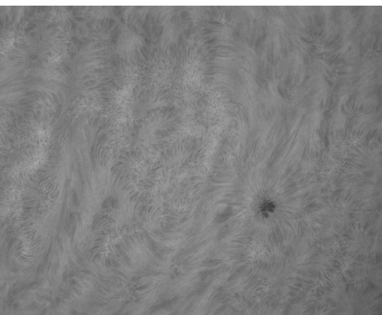
▲ Abb. 2: Unschön: Streifenstrukturen auf einer H \alpha -Aufnahme der Sonne.
