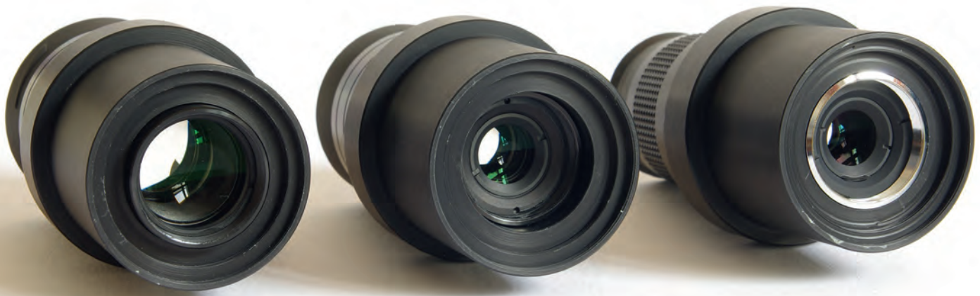
▲ Abb. 6: Der Blick von unten in die Astro-Zoom-Okulare zeigt die Verwendung der okulareigenen Barlowlinse bei den Lacerta-Okularen (16mm links, 7mm Mitte), während die Barlowlinse beim Nagler-Okular (rechts) in der Okularsteckhülse verbleibt.
