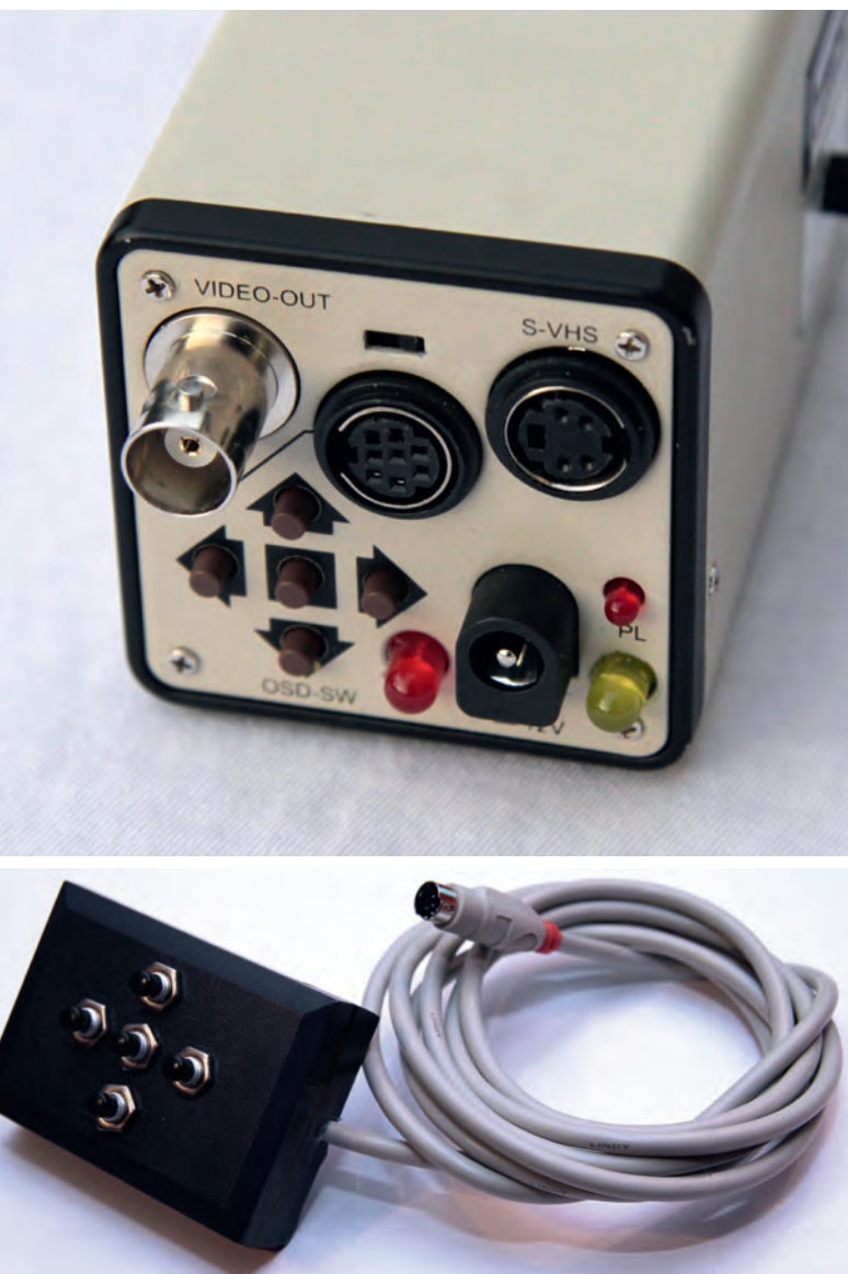
▲ Abb. 3: Die Steuerelemente und Anschlüsse an der Kamerarückseite (oben) und der Handcontroller zur Fernsteuerung der MallinCam (unten).
