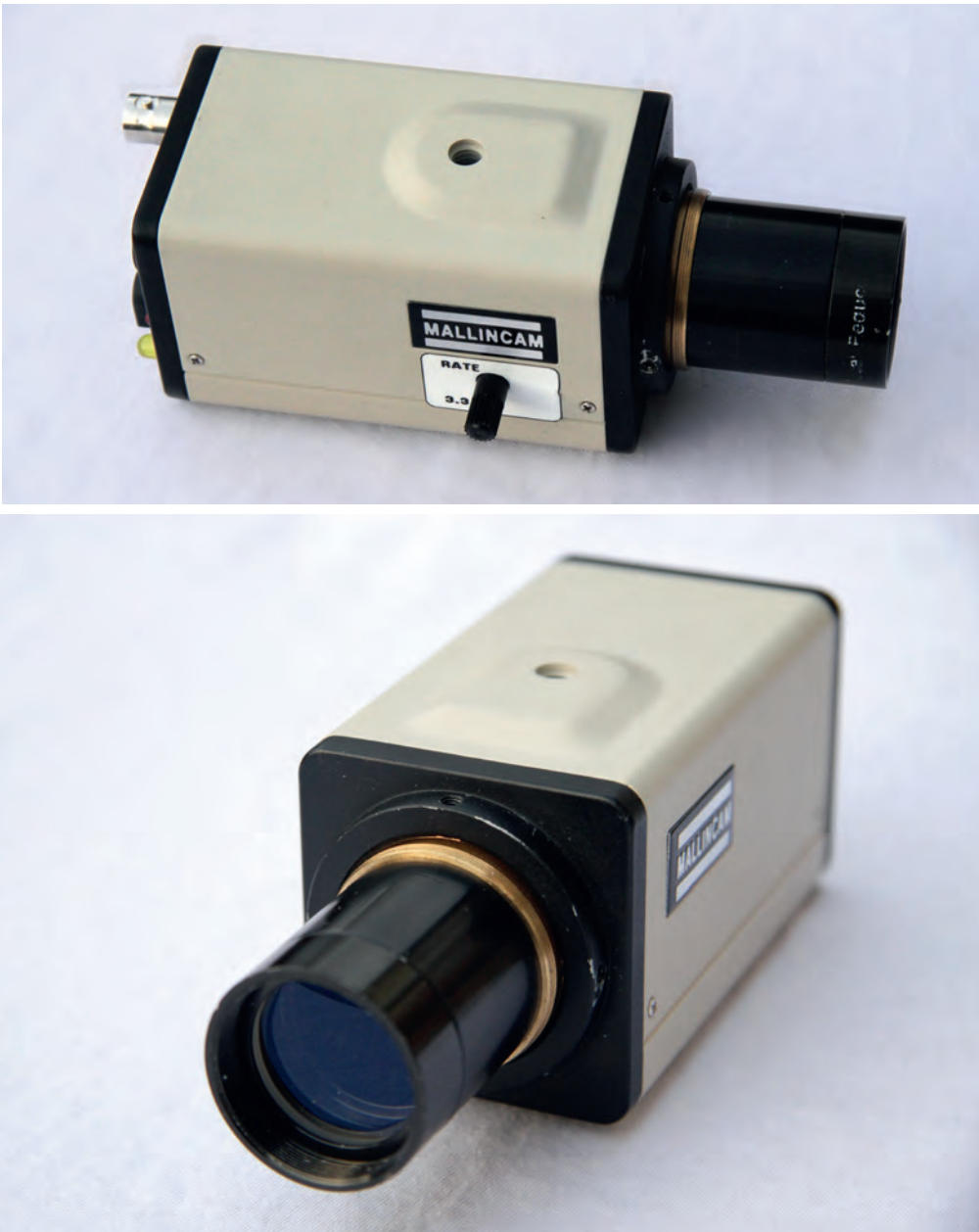
▲ Abb. 2: Das Kameragehäuse (oben) sowie der Okularanschluss mit angesetztem Reducer (unten).
