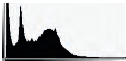
▲ Abb. 2: Histogramm zu Abb. 1. Der Peak auf der rechten Seite zeigt die überbelichteten Pixel der Mondsichel an.
