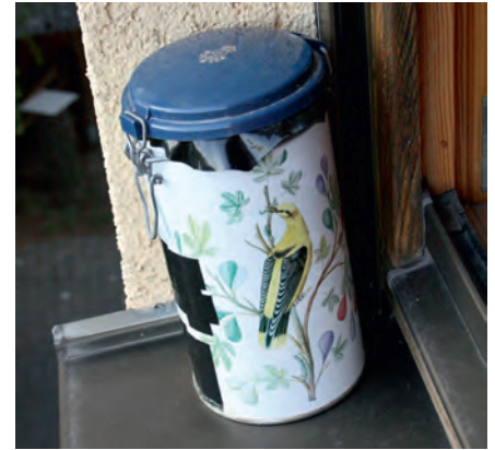
➡ Abb. 5: Auch aus Kaffeedosen lassen sich leistungsfähige Kameras basteln. Der Deckel war etwas transparent und wurde mit schwarzer Folie gesichert. Diese Kamera stand ein halbes Jahr im Fensterbrett, das Klebeband hielt.
