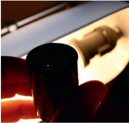
▲ Abb. 3: Prüfung des fertigen Lochkamera (hier: Filmdose ohne Deckel) gegen eine Lampe: Das Loch muss frei sein und darf nicht aus Versehen zugeklebt worden sein.
