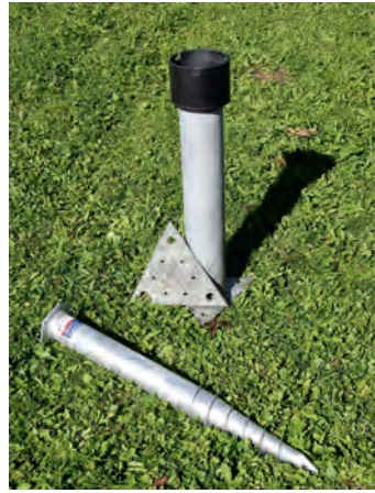
▲ Abb. 2: Fundamentschrauben werden in verschiedenen Größen angeboten: von 50cm bis 250cm Länge. Für die Verankerung der 70cm-Säule wurde eine 80cm lange Schraube gewählt.
