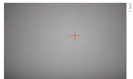
▲ Abb. 6: Testaufnahme eines stark dezentrierten Objektivs: Das Helligkeitsmaximum liegt abseits der Bildmitte (rotes Kreuz).
