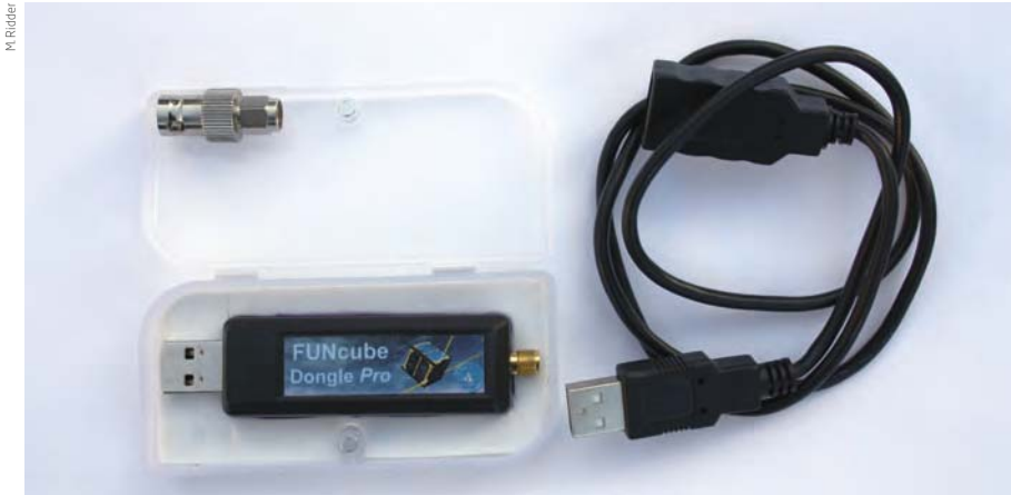
◀ Abb. 3: Der Empfänger: Funcube Dongle Pro, ein »Software Defined Receiver« im Format eines USB-Sticks.
