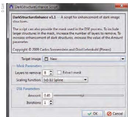
◀ Abb. 7: Das Skript »DarkStructureEnhance« verstärkt Dunkelstrukturen im Bild. Mit der Option »Layers to remove« stellt man die Größe der Dunkelstrukturen ein, die verstärkt werden sollen.
