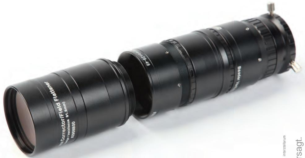
▲ Abb. 5: Um Baaders RCC zu verwenden, muss ein Abstand von 91,5mm zwischen dem Gewindeanschlag des Korrektors und der Feldblende des Okulars eingehalten werden.
