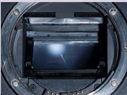
▼ Abb. 3: **Nachdem der Spiegel hochgeklappt ist**, ist der Blick frei auf den Kameraschluss.
