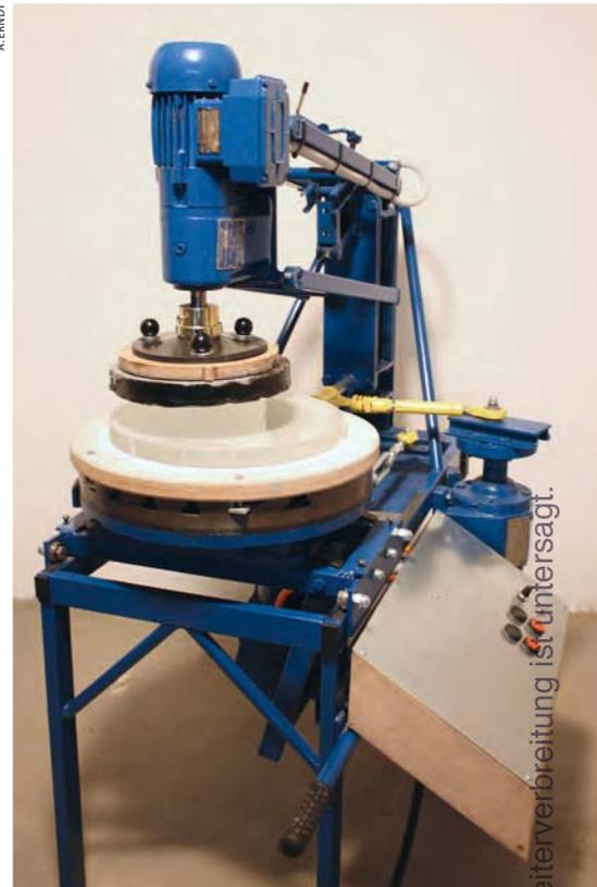
können, muss auch eine Möglichkeit realisiert werden, das Werkzeug anzuheben. Da die Schleifbewegungen von Hand imitiert werden sollen, muss der sich drehende Glasrohling auch noch linear bewegt werden. Alle Bewegungen müssen völlig frei einstellbar und in ihrer Geschwindigkeit regelbar sein. Zusätzlich muss eine Möglichkeit gefunden werden, das oben hängende, sich drehende Werkzeug pendelnd zu lagern und es dabei zu zentrieren.
