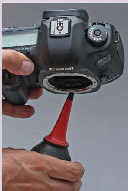
▲ Abb. 5: Beim »Ausblasen« der Kamera mit einem Blasebalg ist die Objektivöffnung stets nach unten zu halten.
