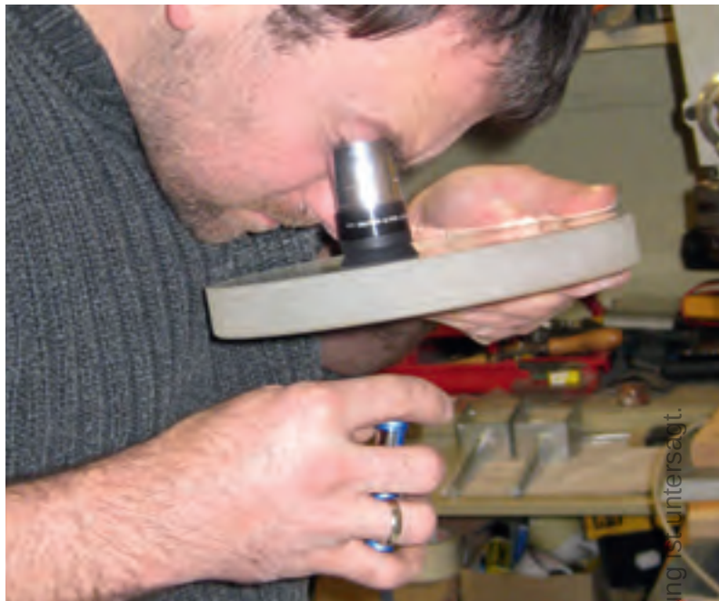
▲ Abb. 5: Mit einem umgedrehten Okular auf der Suche nach Vertiefungen, die vom vorhergehenden gröberen Schleifkorn stammen.
