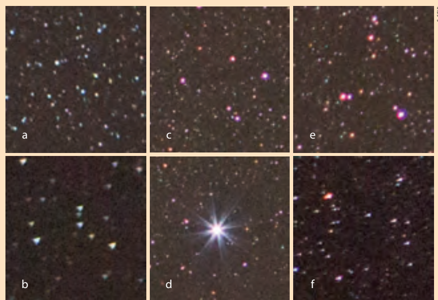
▲ Abb. 3: Auf 200% vergrößerte Darstellung von Testergebnissen, alle aufgenommen mit 135mm Brennweite. Die erste Spalte (a, b) zeigt Ausschnitte eines Fotos, das mit einem 2,8/70–200mm Zoom bei Offenblende entstanden ist. Beide Teilbilder sind etwa gleich weit von der Bildmitte entfernt! Die Abbildungsleistung schwankt erheblich, was auf eine Dezentrierung hindeutet. Auch die zweite Spalte (c, d) zeigt zwei ausgewählte Ausschnitte einer Aufnahme, für die ein 2,0/135mm-Teleobjektiv bei Blende 2,8 verwendet wurde. Enttäuschend ist eine ausgeprägte chromatische Längsaberration trotz Abblendung um eine Stufe (c). Bei hellen Sternen (d) werden Spikes sichtbar, hervorgerufen durch die Form der Blende. Wie das selbe Objektiv bei Offenblende (2,0) abbildet, ist in der dritten Spalte (e, f) ersichtlich, wobei e die Bildmitte, f eine Bildecke des Vollformatsensors repräsentiert. Die chromatische Aberration ist bei Offenblende naturgemäß noch stärker (e), die Abbildungsleistung in den Bildecken (f) nicht perfekt, aber in Anbetracht der hohen Lichtstärke noch akzeptabel.
