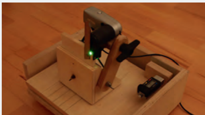
▼ Abb. 2: Der Foucault-Tester. Er wird benötigt, um die Glasfläche optisch vermessen zu können.
