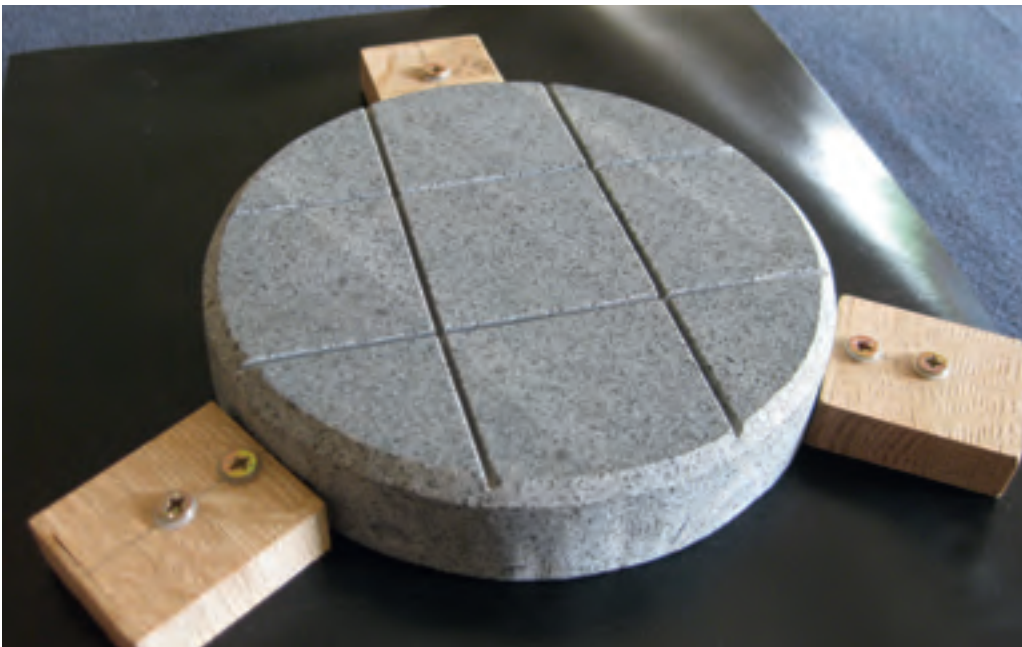
◀ Abb. 2: Das fertig vorbereitete Werkzeug aus Granit. Auf ihm wird der Glasrohling geschliffen.
