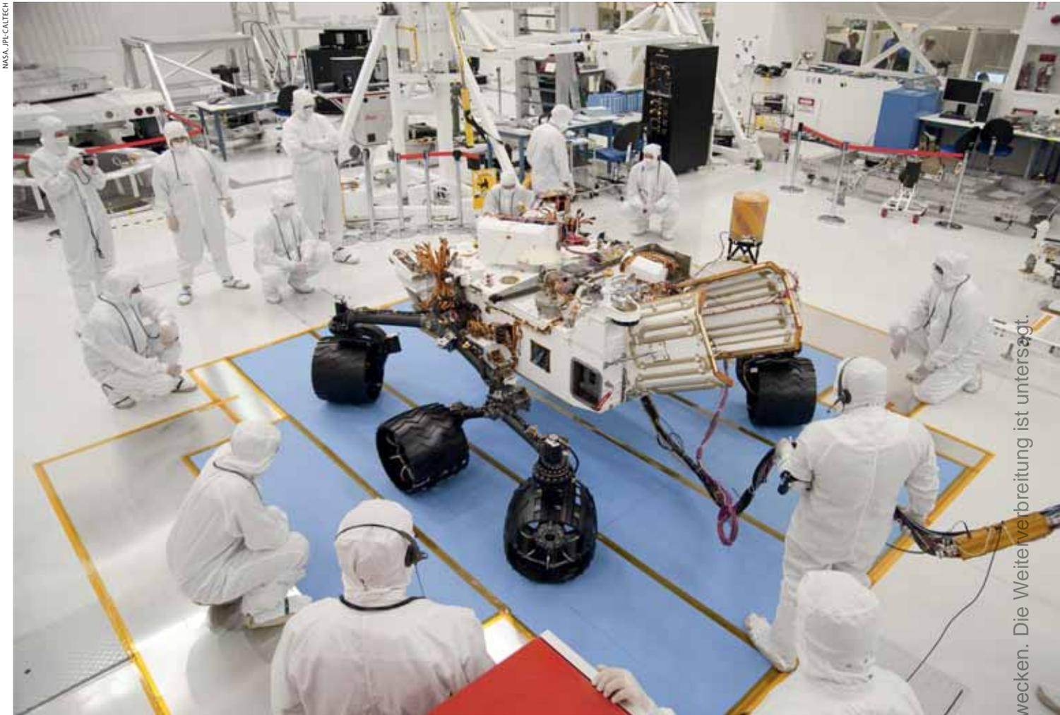
▲ Abb. 6: Das Flugmodell des neuen Marsrovers Curiosity, bei seiner ersten Testfahrt in einem großen Reinraum des Jet Propulsion Lab in Kalifornien 2010: das erste Fahrzeug für einen anderen Planeten von der Größe eines Kleinwagens.
