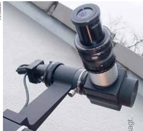
▲ Abb. 5: **Geschlossener Newtonblick** mit Klappspiegelbox (Vixen) und schwenkbarer Schnellwechselbefestigung (Ringschwalbe) am Kameraausleger des Schüsselteleskops. Beim Wegklappen des Spiegels wird der Abbildungsstrahl freigegeben für die hochauflösende Videokamera (hier: Chameleon von Point Grey mit 3,75µm Pixelraster), die über einen kurzbauenden Schneckenfokussierer (Borg) mit aufgesetzter 2,2x-Barlowlinse am ausgangsseitigen Ende des Kamerahalters montiert ist.
