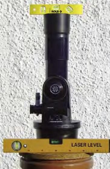
**Abb. 5: Ausrichtung des ETX nach Norden**, um mit Hilfe des Polarsterns die Polhöhenwiege auf die geographische Breite einzurichten. Zur Erhöhung der Genauigkeit ist ein Fadenkreuzokular eingesteckt.
