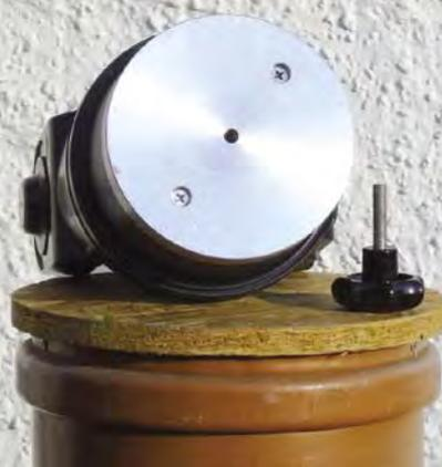
ETX auf der Polhöhenwiege wurde in diesem Fall mit einer Platte aus Aluminium verwirklicht, die unter der Basis des ETX angeschraubt wird (Abb. 3). Dort befinden sich zwei Gewindelöcher mit Fotogewinde, mit denen das Teleskop auf der Original-Polhöhenwiege von Meade befestigt wird. Mit einem zentralen M10-Gewindeloch in der Aluminiumplatte kann das ETX mit einer Schraube auf der Polhöhenwiege befestigt werden.
