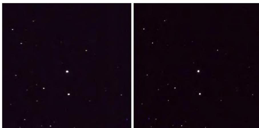
**Abb. 7: Aufnahme mit 820mm Brennweite.** Die Nachföhrbrennweite betrug 355mm und man erkennt deutlich die leicht eiförmigen Sterne in der linken Aufnahme, die mit dem SynGuider nachgeföhrt wurde. Die Sterne in der rechten Aufnahme, nachgeföhrt mit dem SG-4, sind kreisrunde Scheibchen.
