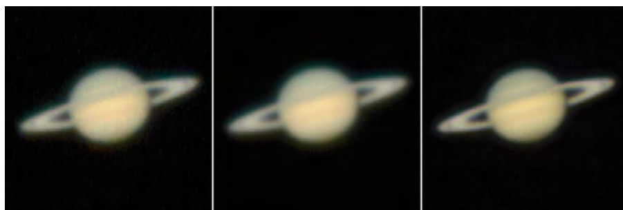
Abb 2: Aufnahme des Planeten Saturn mit einer normalen Fotokamera. Ganz links ist ein Einzelbild zu sehen, entsprechend stark ist das Rauschen. Das Foto in der Mitte entstand durch die Addition und Mittelwertbildung von nur vier Aufnahmen, wodurch sich das Signal-Rausch-Verhältnis bereits verdoppelt hat. Für das Endprodukt rechts wurden 30 Einzelbilder verarbeitet und anschließend geschärft.
