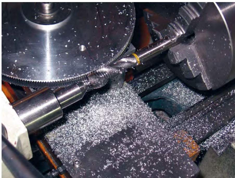
Abb. 6: Ein Gewindebohrer dient als Fräs Werkzeug. Die anfallenden Späne müssen während des Fräsens laufend entfernt werden.
