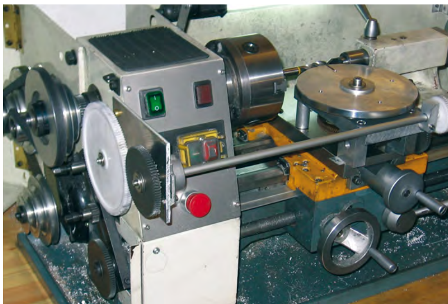
Abb. 4: Die Fräseinrichtung angebaut an die Drehmaschine. Eine beweglich gelagerte Welle verbindet das Übersetzungsgetriebe (links) mit dem Leitgetriebe (rechts).
