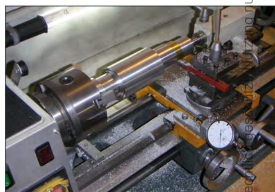
Abb. 10: **Mit dieser Drehmaschine wurden alle Teile hergestellt.** Das Bild zeigt die Bearbeitung der Passungen der Rektaszensionsachse für Lager und Schneckenrad.
