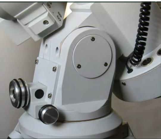
Abb. 4: **Der Polblock ist über einen Flansch mit Hohlkehle mit dem Rektasziensgehäuse verschraubt.** Die Bauteile sind zusätzlich großflächig verklebt.
