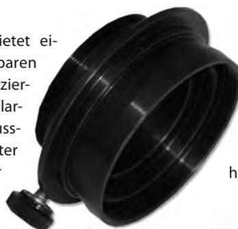
auf. Okularseitig beträgt der Steckdurchmesser 1,25" (31,8mm). Außerdem sitzt hier ein T2-Bolzenschraubgewinde (M42×0,75). Der schwarz eloxierte Alukörper kann damit für vielseitige Anpassungen an Instrumenten mit 2"-Steckanschluss verwendet werden, an denen 1,25"-Zubehör benutzt werden soll.
