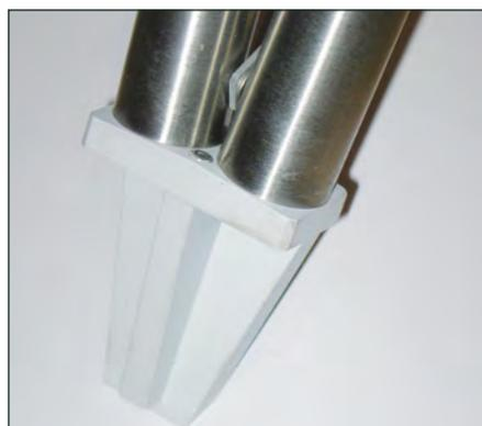
Abb. 9: **Der Stativfuß setzt das für die Steifigkeit optimale Dreieck bis zum Auflegepunkt fort.**
