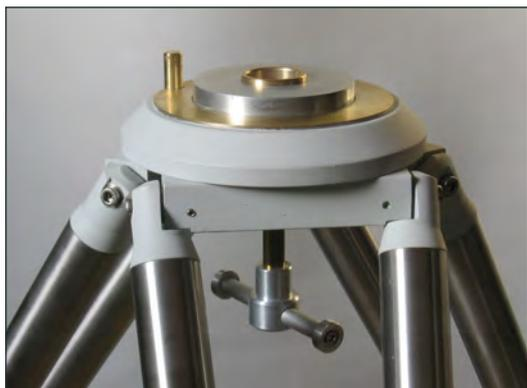
Abb. 8: **Am Stativkopf sind die Stativbeine schwenkbar gelagert.** Die Gleitflächen zur Montierung sind in Messing ausgeführt.
