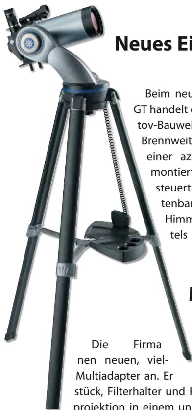
Beim neuen Meade Teleskop DS-2090 MAK GT handelt es sich um einen Reflektor in Maksutov-Bauweise mit 90mm Öffnung und 1250mm Brennweite (Öffnungsverhältnis f/14), der auf einer azimuthalen Einarmgabelmontierung montiert ist. Das vollständig computergesteuerte Teleskop ist mit einer Objektbank von über 1400 gespeicherten Himmelsobjekten ausgestattet, die mittels der mitgelieferten Handsteuerbox
