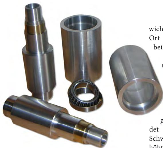
Abb. 2: **Die beiden Hauptachsen** und die zugehörigen Lagergehäuse. In der Bildmitte ist eines der vier Kegelrollenlager zu sehen.
