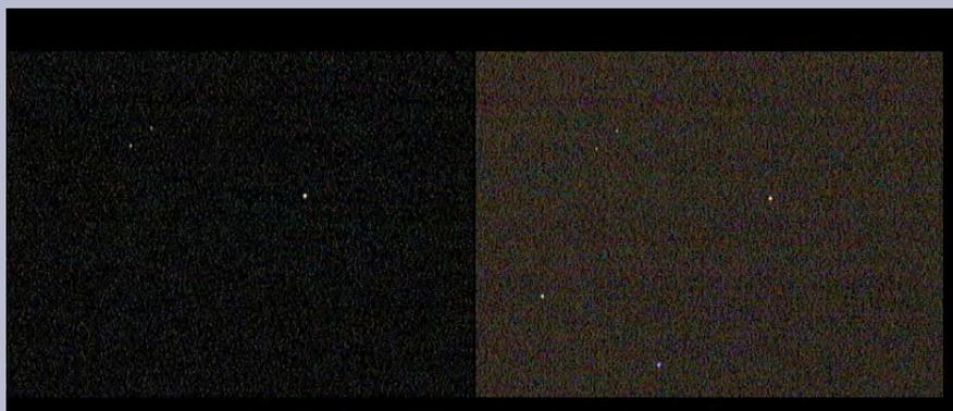
Abb. 6: **Mit Hilfe der Dunkelbildkorrektur** können Hotpixel wirkungsvoll reduziert werden. Besonders praktisch ist es, dass die Funktion nur einen Mausklick braucht, um aktiviert zu werden. Wird die Empfindlichkeit oder Belichtungszeit der Kamera verändert, sollte man die Dunkelbildkorrektur wiederholen.
