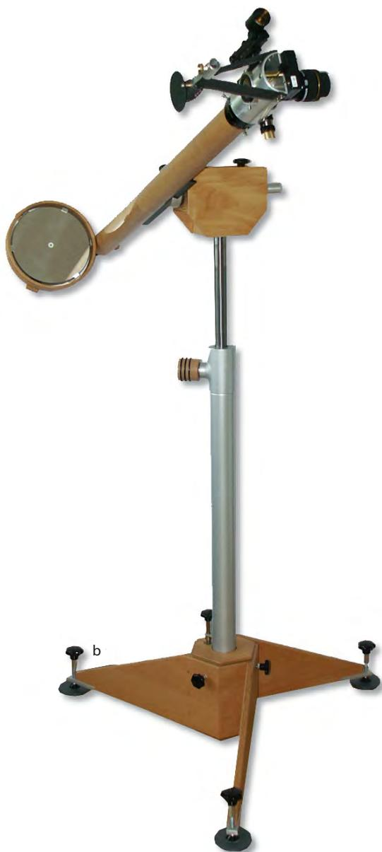
Abb. 1: Ein Beispiel astro-mechanischer Handwerkskunst ist der einarmige 8"-Newton von Markus Emmerich. Über einen Hydraulikzylinder, der gleichzeitig die Stativsäule bildet, kann die Einblickhöhe verändert werden (a). Am unteren linken Ende der Säule befindet sich das Fußpedal, mit dem der Zylinder ausgefahren wird. Zum Absenken wird am oberen linken Ende der Säule mit dem Holzknopf ein Ventil geöffnet (b).
