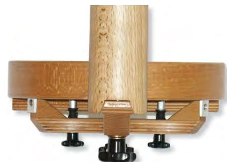
Abb. 6: Die Montierung besteht aus Buche Multiplex. Insgesamt sind vier Kugellager verbaut. Über Sterngriffe werden die weißen Kunststoffblöcke geklemmt und somit die Achsen gebremst.
