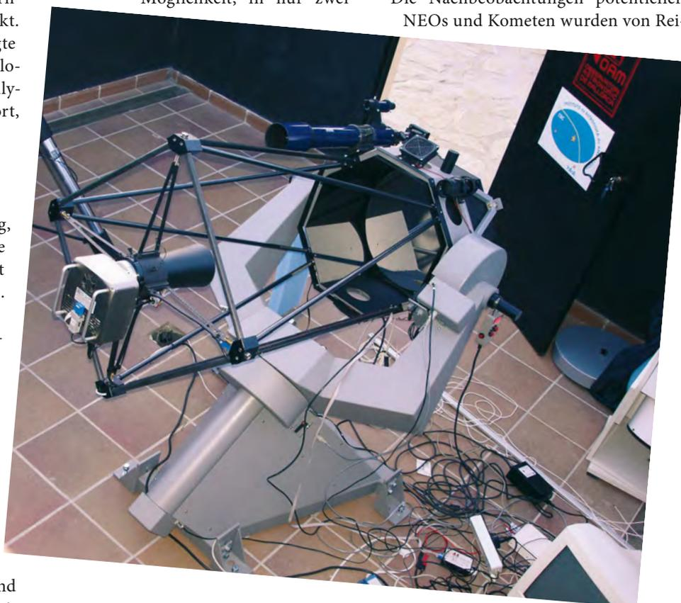
Abb. 1 **Das 450mm f/2,8-Teleskop**, das größte und auch effektivste Teleskop der Sternwarte La Sagra, ausgestattet mit einer SBIG STL-11000M CCD-Kamera. Mit diesem Teleskop wurde auch 2007 NS2 entdeckt.
