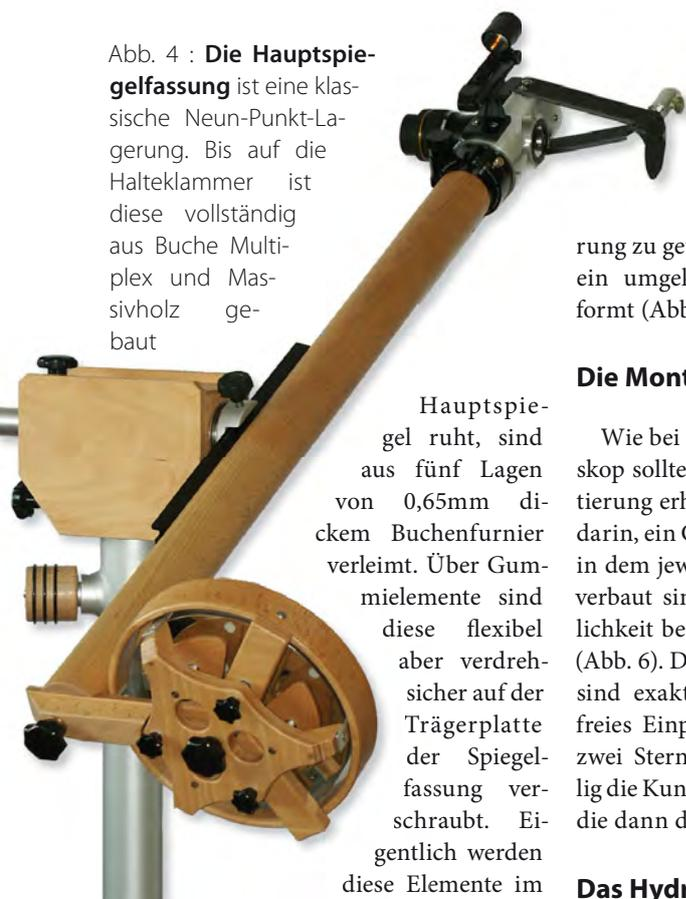
Hauptspiegel ruht, sind aus fünf Lagen von 0,65mm dickem Buchenfurnier verleimt. Über Gummielemente sind diese flexibel aber verdrehsicher auf der Trägerplatte der Spiegelfassung verschraubt. Eigentlich werden diese Elemente im
