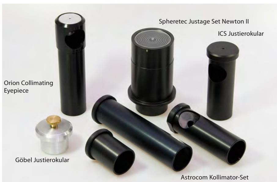
Abb. 3: **Justierokulare erzeugen Muster**, anhand derer die Justage erleichtert wird. Hintere Reihe von links: Orion Collimating Eyepiece, Justage Set Newton II von Spheretec, ICS Justierokular. Vordere Reihe von links: Göbel Justierokular sowie das dreiteilige Astrocom Kollimator Set.
