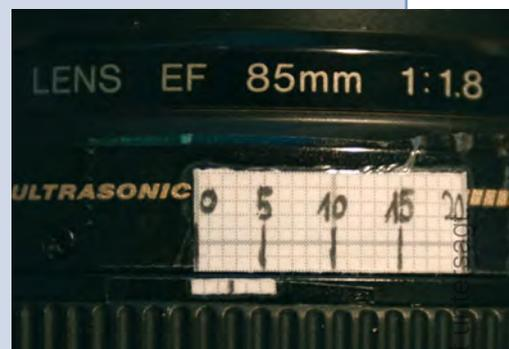
Abb. 1: Die Millimeterpapier-Skala erleichtert nach einmaliger Justierung mit einem Testfoto die Fokussierung wenn nachts im Sucher kaum etwas zu erkennen ist.
