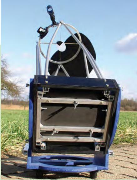
Abb. 2: **Die Unterseite der Spiegelzelle** aus vernieteten 10mm-Alukantrohren.
