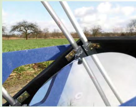
Abb. 5: **Die Rockerbox mit seitlich angeschraubten Führungsschienen für die Spiegelbox.** Ebenfalls zu erkennen ist die untere Halterung der Tubus-Stangen mit der Verstärkung aus Messing.
