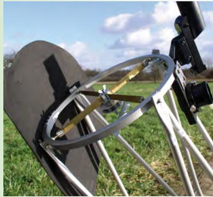
Abb. 4: **Verbindung der Tubus-Stangen mit dem Hut**, in dem die Spinne mit dem Sekundärspiegel sitzt. Mit Hilfe eines Holzbrettchens ist der Okularauszugs am Ring befestigt.
