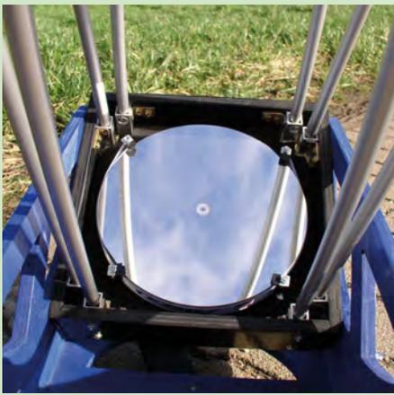
Abb. 3: **Blick in die Spiegelbox.** Am Rand der Halterung sind Gewindestangen zu erkennen, mit denen das Halterungsband gestrafft wird, unten sieht man die Stangen, die ein seitliches Wegrutschen des Spiegels verhindern.
