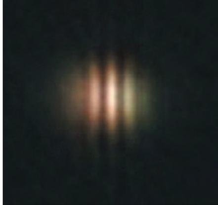
Abb. 2: **Interferenzstreifen bei der Abbildung eines einzelnen Sterns** durch eine Doppellochblende mit 40mm-Öffnungen und einem Abstand von 100mm, ohne Filter. Als Teststern diente Kapella.
