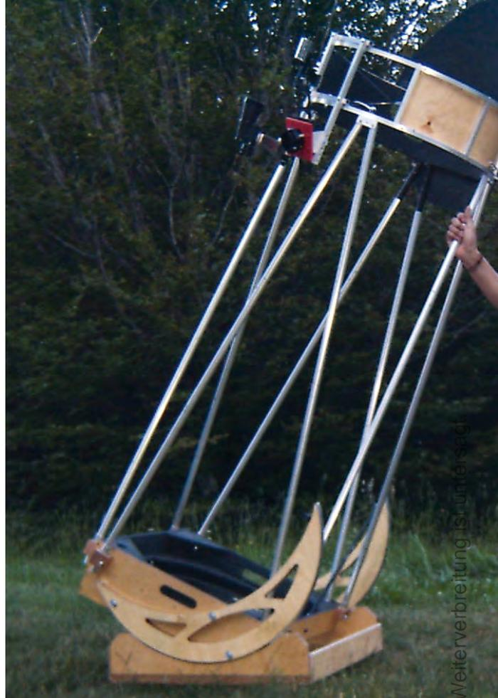
Abb. 1: Ein Newton-Teleskop mit einem weniger als  $90^\circ$  durch den Fangspiegel abgelenkten Strahlengang wird als »Lowrider« bezeichnet. Beim 22"  $f/4$ -Dobson des Autors mit 2200mm Brennweite konnte die Okular-Einblickhöhe auf unter 1,65m »tiefer gelegt« werden, so dass selbst bei Zenitstellung des Teleskops ohne Leiter oder Tritt beobachtet werden kann.
