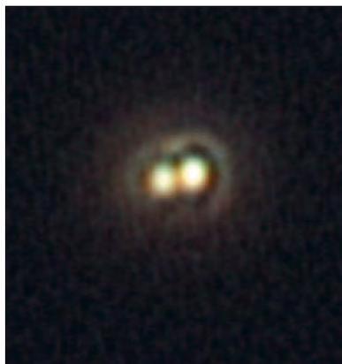
scharf stellen würde. Von außeraxialer Scharfeinstellung rate ich also ab. Man sollte auf jeden Fall versuchen, in der Bildmitte die beste Schärfe zu erzielen und notfalls die Ecken, die sowieso teilweise abgeschattet sind, einfach abschneiden.
