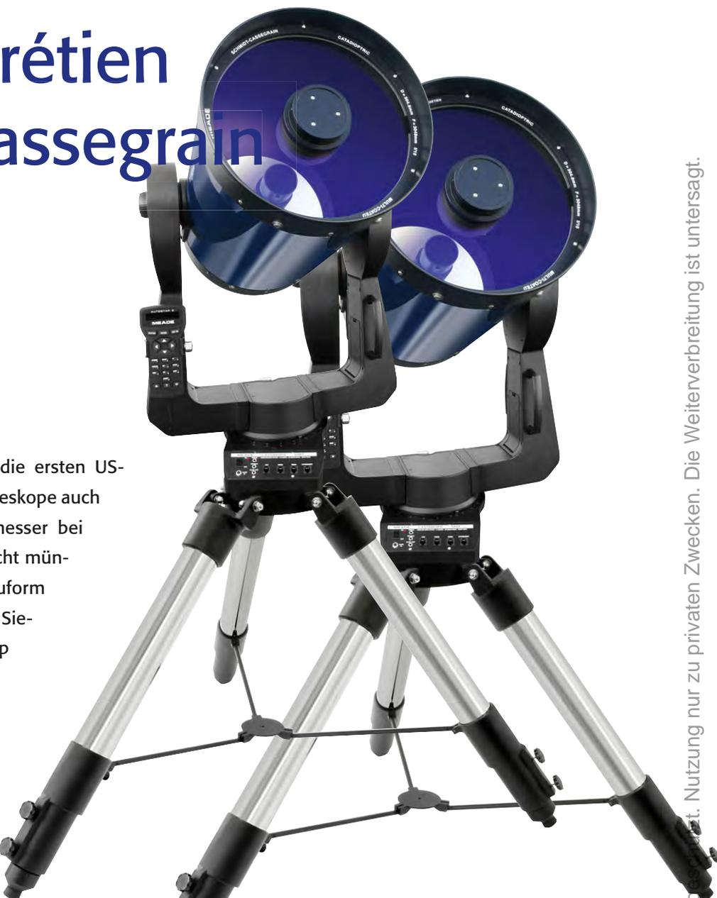
Hauptspiegel mit einem Öffnungsvon etwa  $f/2$ . Dieser reflektiert das einfallende Licht auf einen ebenso sphärischen Fangspiegel (teils mit asphärischer Korrektur), der kurz vor dem Brennpunkt des Hauptspiegels sitzt und die Brennweite des Hauptspiegels etwa um den Faktor 5 verlängert. Das System hat ein resultierendes Öffnungsverhältnis von ca.  $f/10$ .
