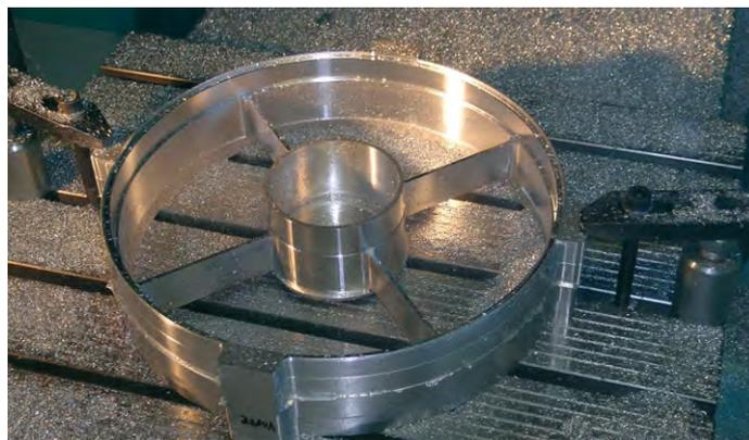
Abb. 6: Der Zwischenring zur Verlängerung des Tubus für den Selbstbau eines nicht-kompakten SCT, herausgefräst aus einem Aluminium-Vollblock.
