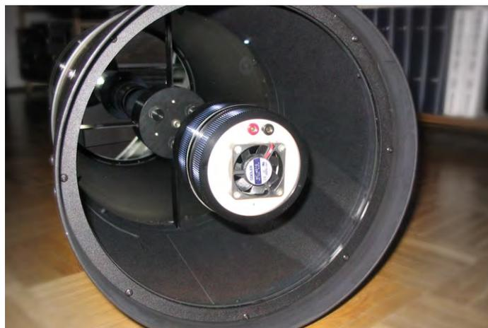
Abb. 7: Einblick in den modifizierten Tubus. Ein Lüfter sorgt für schnelleren Austausch der Tubusluft.
