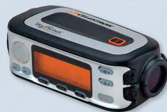
Lange angekündigt, nun auch bei uns: Der Celestron Skyscout – nicht zu verwechseln mit dem gleichnamigen Kartenset aus dem Oculum-Verlag – ist eine völlig neuartige elektronische Mischung aus Peilsucher, Digitalen Teilkreisen und GPS-Empfänger. Richtet man das Visierrohr
