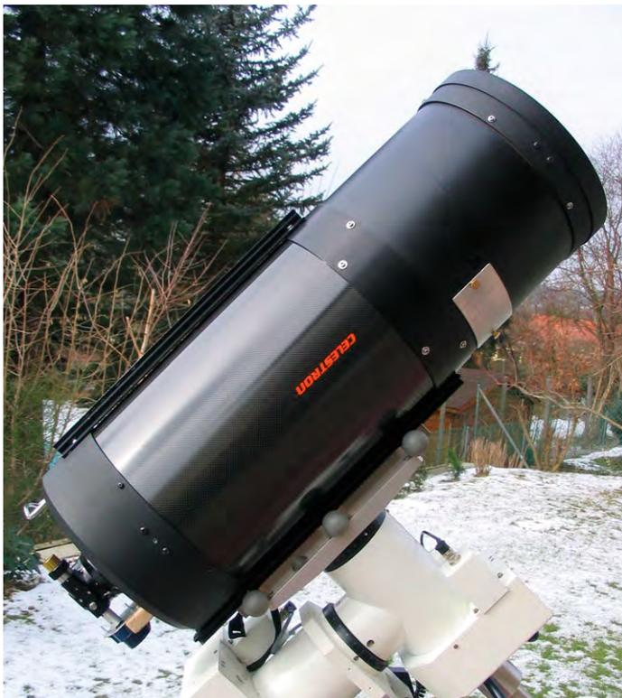
Abb. 8: Aufbau des modifizierten C11 für die Astrofotografie. Durch den Umbau ist der Tubus um 30cm länger und 2kg schwerer geworden.
