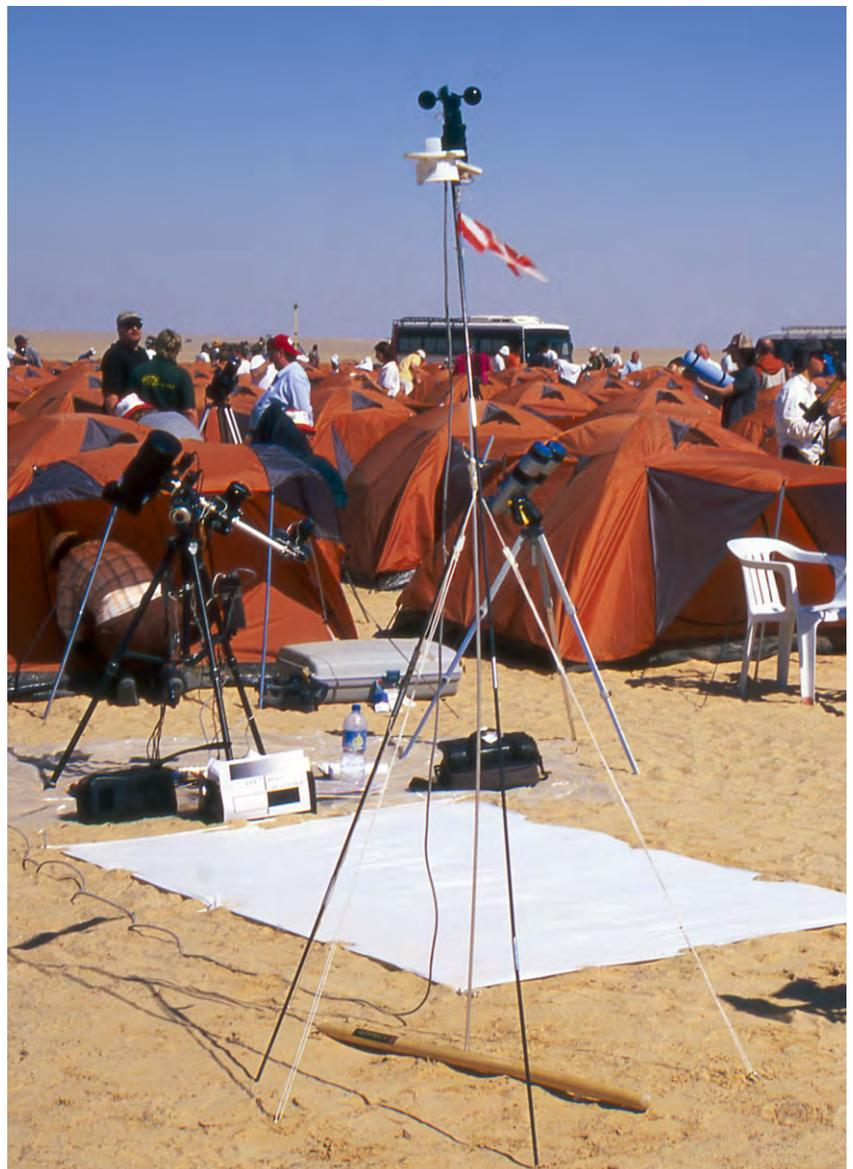
Abb. 2: Die Ausrüstung für Wetterbeobachtungen während der Finsternis, a) Das von J. Mosch benutzte Messgerät mit Abschattung und Wetterfahne zur exakten Ausrichtung im Wind, b) Die Ausrüstung des Autors. Auf einem Mast befindet sich ein Helligkeitssensor, Windmesser und unter der Abschattung ein Thermosensor.
