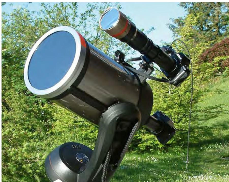
Abb. 2: Ohne sichere Filterung des Sonnenlichts kann die Sonnenbeobachtung zur sofortigen Erblindung führen! Die Abbildung zeigt ein mit Glasfilter ausgestattetes Teleskop, während das Teleobjektiv mit einer Folie abgedeckt ist. [Ulrich Dittler]
