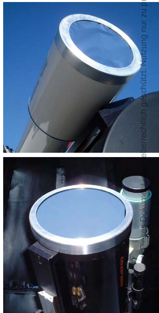
Abb. 1: Die Verwendung von Objektivfiltern ist heute die bevorzugte Methode für teleskopische Sonnenbeobachtungen. Dabei verwendet man Folienfilter (oben) oder bedampfte Glasfilter (unten). [Pedro Ré]
