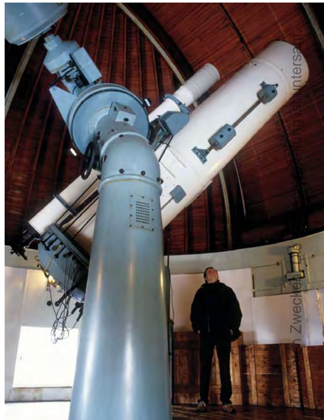
Das Hauptteleskop der Sternwarte Sonneberg, ein 500mm-Schmidtspiegel. [Stefan Binnewies]
