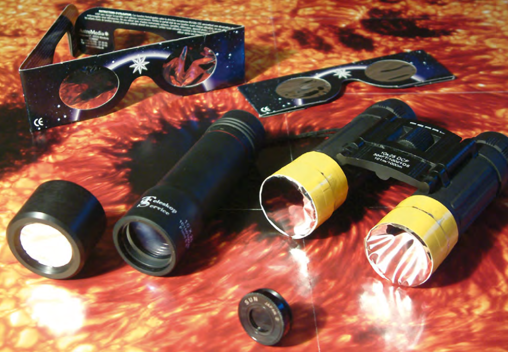
Abb. 1: Utensilien für die Sonnenbeobachtung: Eine Sonnenbeobachtungsbrille (hinten) ermöglicht die gefahrlose Sonnenbeobachtung mit bloßem Auge. Ein Fernglas kann zur Sonnenbeobachtung ebenso wie ein Teleskop mit Filterfolie ausgestattet werden (rechts); für Teleskope gibt es auch Glasfilter zum Aufstecken (links). Auf keinen Fall verwendet werden sollten Okularfilter, die Einsteigerteleskopen beiliegen (vorne). [Ulrich Dittler]
