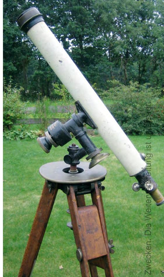
Abb. 1: Der 54mm-Refraktor von Merz war der Ahnherr aller Schulfernrohre. Das abgebildete Exemplar hat als eines der wenigen die Weltkriege überdauert. Die abgebildete Montierung gehört nicht zur ursprünglichen Ausstattung. [Christian Harder]
