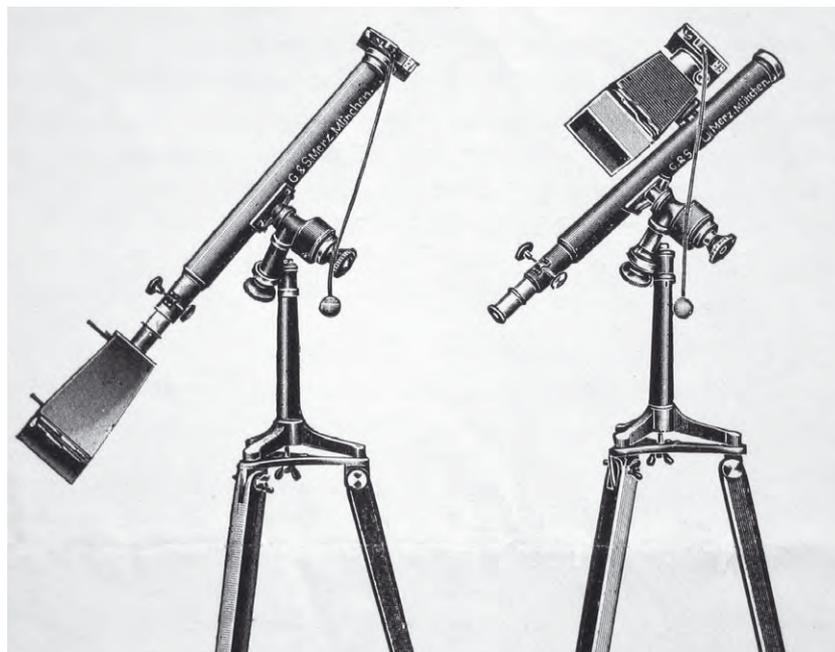
Abb. 3: Astrofotografie um 1930: Die Katalog-Abbildung zeigt links eine Plattenkamera für Mondaufnahmen mit Verschluss am Objektivende des Teleskops. Die rechte Anordnung dient der Sternfotografie ebenfalls auf eine Fotoplatte von  $9\text{cm} \times 12\text{cm}$ . Die Nachführung erfolgte von Hand – ohne Feinbewegungen sicherlich ein schwieriges Unterfangen. [G. & S. Merz GmbH, Instrumente für Liebhaberastromen, Schulfernrohre und Spiegelteleskope, 1930]
