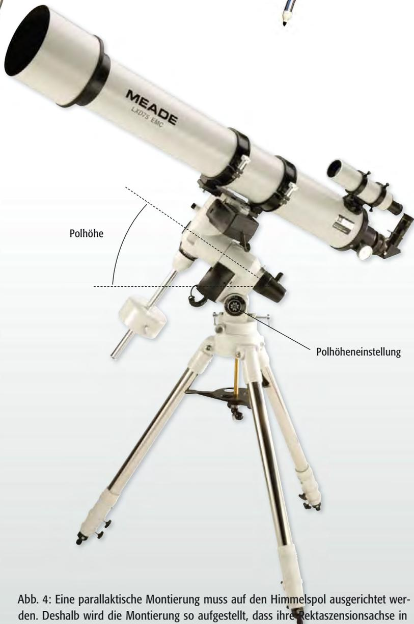
Abb. 4: Eine parallaktische Montierung muss auf den Himmelspol ausgerichtet werden. Deshalb wird die Montierung so aufgestellt, dass ihre Rektaszensionsachse in Richtung Pol zeigt. Dazu muss die Polhöhe richtig eingestellt sein, bei uns je nach geographischer Breite auf einen Winkel zwischen ca. 48° und 55°. [Meade Europe]
