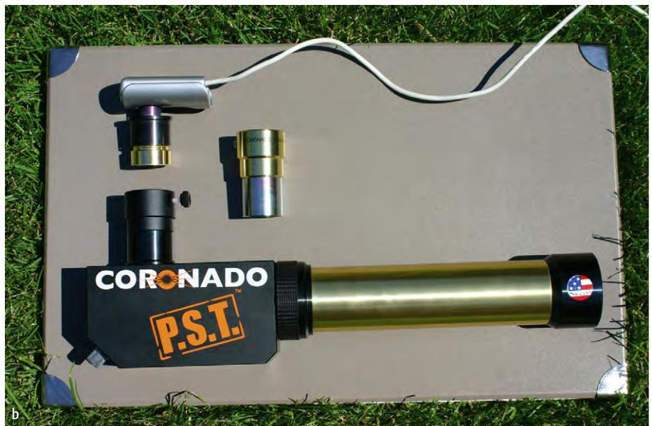
Abb. 2: Für die fotografische Nutzung sind leichte Modifikationen nötig. a) Kürzung des Okularauszugs durch Herausschrauben der Hülse, b) Adaption des Cemax-Barlowlinsenelements ohne Hülse mit der Kamera.
