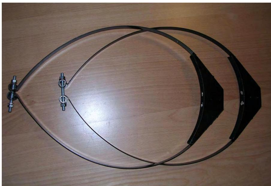
Abb. 3: Befestigung aus Stahlspannbändern für ein 11"-SCT.
