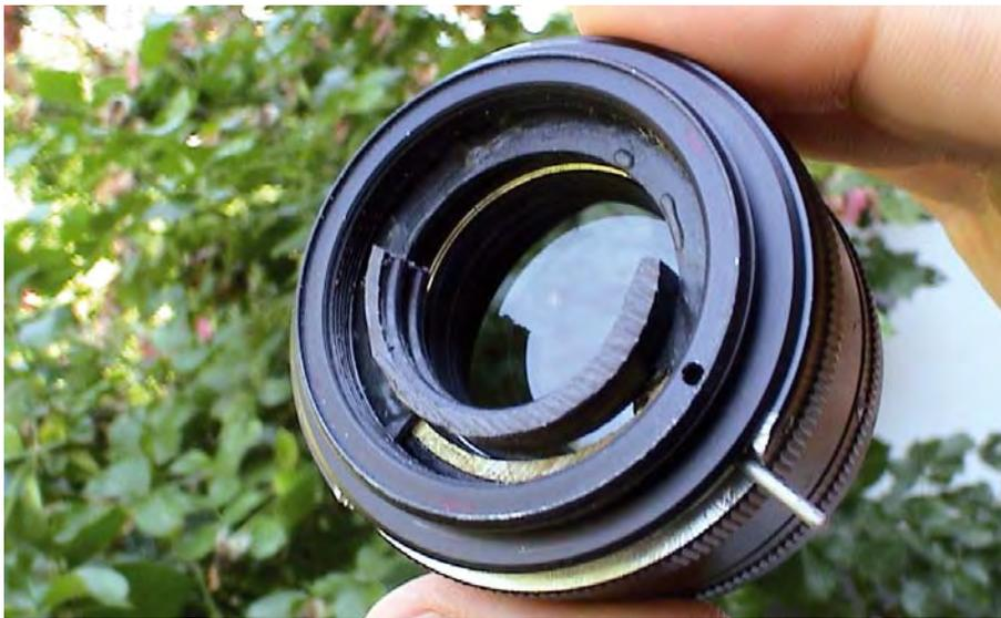
Abb. 3: Selbstbau einer drehbaren Filterfassung mit Polarisationsfilter. Verwendet wurden 42mm-Zwischenringe für Photoobjektive und Kunststoffringe. Die Filterfassung wird im Cassegrainfokus zwischen Teleskop und CCD-Kamera montiert. Der Polarisationsfilter kann zwischen zwei Aufnahmen gedreht werden, ohne dass sich die übrigen Parameter der Aufnahme ändern. [Nikolaus Steenken]
