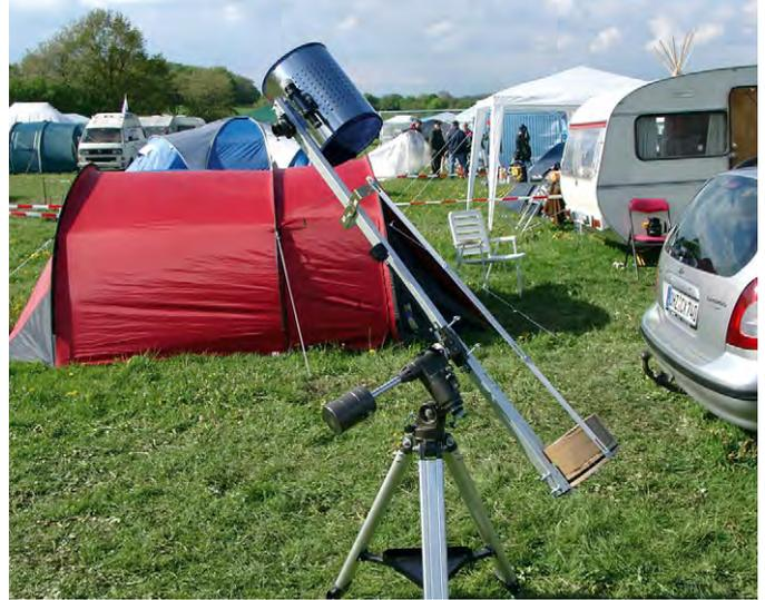
Abb. 5: Michael Suchodolski hat beim Bau seines 8"-Newtons mit selbst geschliffenem Spiegel auf ungewöhnliche Materialien (Wasserwaage, Papiereimer) zurückgegriffen und daraus eine abgewandelte Bügelbrettmontage geschaffen. Trotz einiger mechanischer Unzulänglichkeiten der Konstruktion war die Jury von der Experimentierfreude und Beharrlichkeit des Erbauers angetan. [Wolf-Peter Hartmann]
