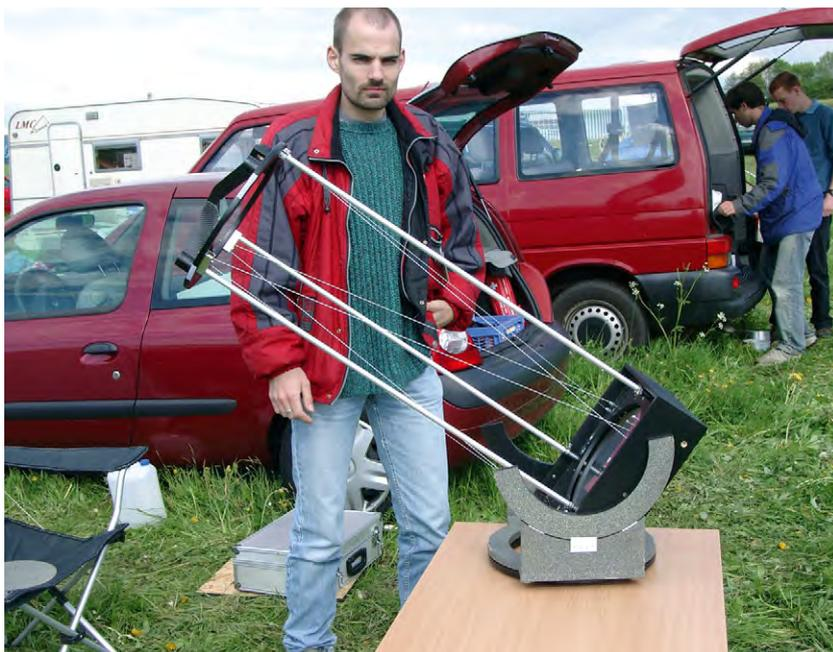
Abb. 1: Christian Liesenfeld realisierte an seinem 9kg leichten 10"-Dobson eine völlig neuartige Konstruktion der oberen Tubuselemente. Der Sekundärspiegel wird in die Ebene der nicht justierbaren Spinne verlagert, so dass hier üblicherweise auftretende Kippmomente weitgehend vermieden werden. Die Justierung des gesamten oberen Tubusringes inkl. Sekundärspiegel ist über das auf Federn gelagerte Drei-Rohr-Gestänge mittels Spannschrauben realisiert. [Wolf-Peter Hartmann]
