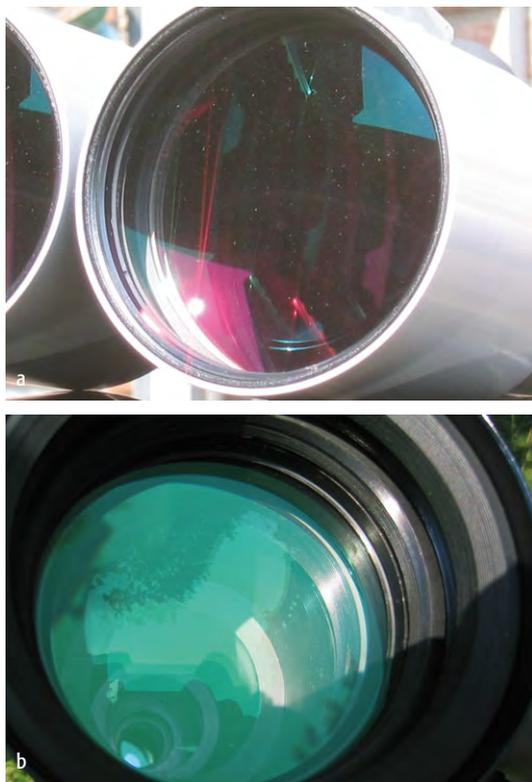
Abb. 3: Die Objektive der Ferngläser im Vergleich. Miyachi (a) bietet 77mm Öffnung, während die Objektive von Teleskop-Service (b) nominell 88mm Durchmesser besitzen, tatsächlich aber nur 87mm nutzbar sind.
