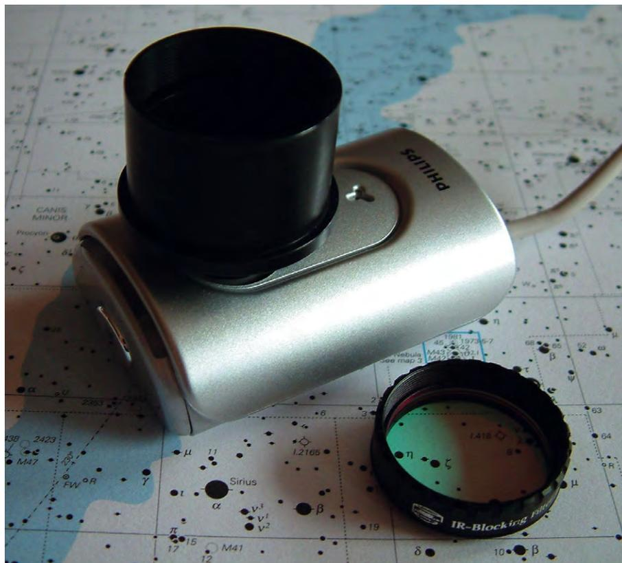
Abb. 1: Die Webcam-Ausrüstung des Sternfreunds: Philips ToUCam 840 Pro II mit Teleskopadapter und IR-Filter.
