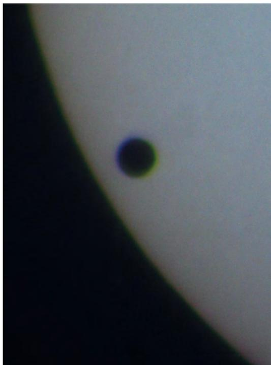
Abb. 9: Foto-Dokument mit Farbrändern: Venustransit am 8. Juni 2004 (Lidl-Refraktor mit Objektiv-Folienfilter und hinter das Okular gehaltener Digitalkamera Canon G3).
