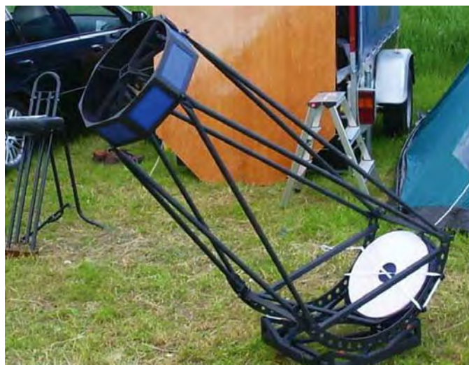
Jörg Peters 14"-Reisedobson wiegt komplett sage und schreibe 14kg, ist trotzdem sehr steif und schwingungsarm und lässt sich nach diversen Verbesserungen noch besser nachführen. Zum Transport passt er in eine Tasche mit Handgepäck-Maßen. [Foto: Martin Trittelvitz]
