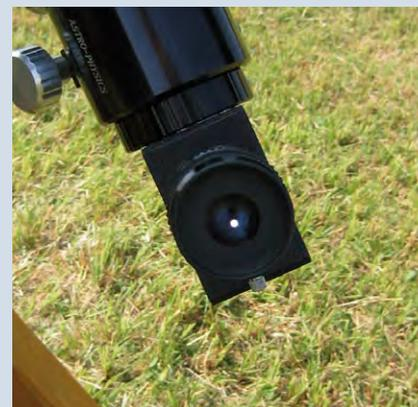
Mit der Erhöhung der Vergrößerung sinkt der Durchmesser des aus dem Okular austretenden Lichtbündels, der Austrittspupille.
