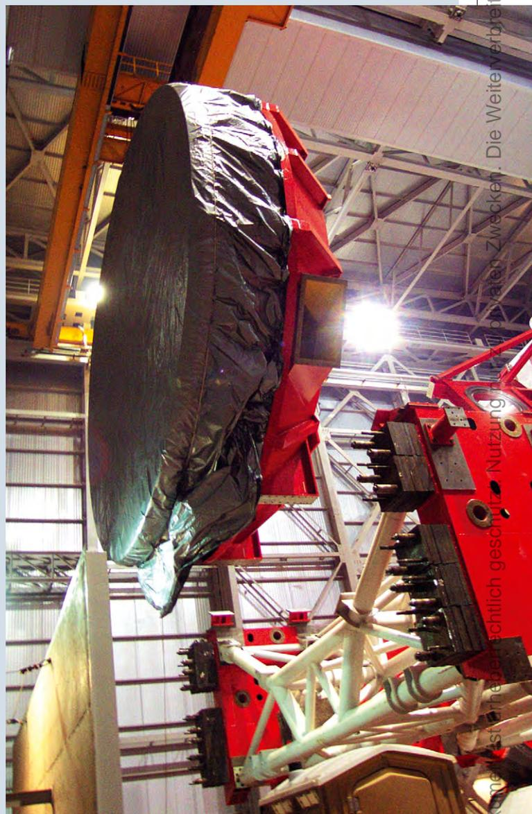
Der (abgedeckte) 8,4m-Spiegel in seiner Halterung beim Einbau ins Large Binocular Telescope.
