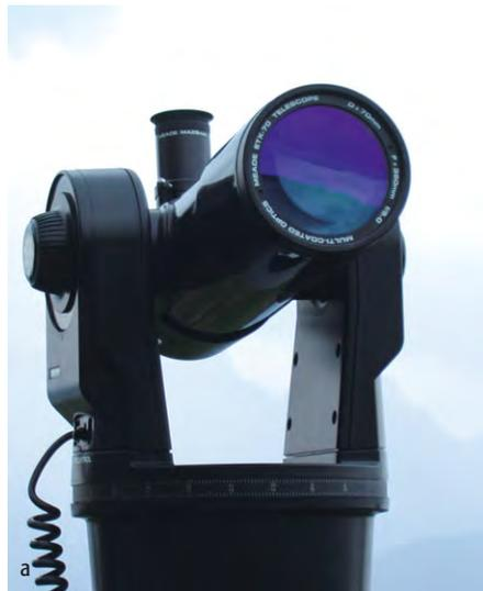
Abb. 3: Das kleine Meade ETX-70 ist kein Schmidt-Cassegrain wie seine größeren Brüder, sondern ein 70/350-Refraktor (a). Der Blick in den Tubus zeigt die Fokussierung durch Verschieben der Objektivgruppe mittels einer Schraube (b).
