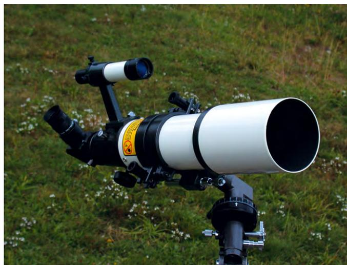
Abb. 4: Stärke des GSO-Refraktors ist der 2"-Okularauszug bei einem Öffnungsverhältnis von f/6. Dadurch wird der mitgelieferte Sucher überflüssig, denn ein 40mm-Okular bietet schon über 5° wahres Gesichtsfeld.
