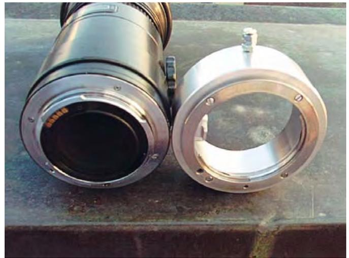
Abb. 3: Ein Blick in den Adapterring zur Lasche, welche die Blende während der Montage öffnet.
