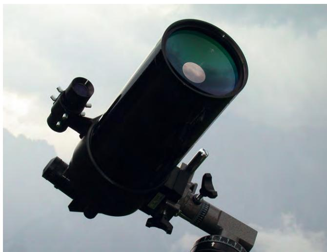
Abb. 5: Der Maksutov von Teleskop-Service ist kompakt und bietet dennoch eine beachtliche Brennweite von 1400mm.
