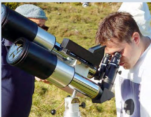
Abb. 2: Der Doppelrefraktor ist ein Eigenbau und handwerklich allererste Sahne. Nun hat der Erbauer das Bino-Problem lediglich durch unterschiedlich langes Abknicken des Strahlenganges gelöst – und den Augenabstand? Durch den Höhenversatz beider Refraktoren lässt sich auch dieses Problem einfach lösen! Ich war begeistert!
