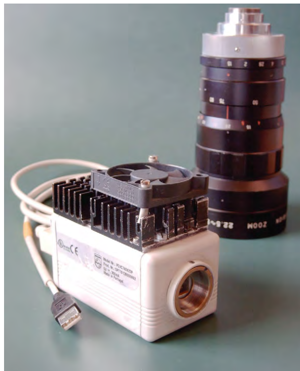
Abb. 1: Ansicht der zur digitalen Astrokamera umgebauten ToUcam Pro SC mit C-Mount-Anschluss und aktiver Kühlung. Daneben ist das 22,5–90mm-Video-Zoomobjektiv zu sehen, mit dem Abb. 6 entstand.
