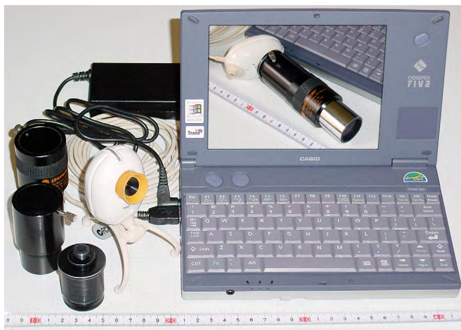
Abb. 2: Das nach Namibia mitgebrachte Instrumentarium: Webcam, Barlowlinse mit Verlängerungshülse und Notebook.
