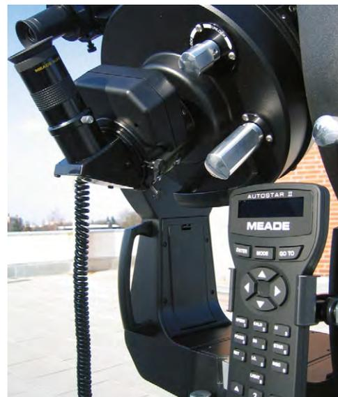
Abb. 3: Die Handsteuergeräte im Vergleich. a) Beim Meade-Computer kann man komfortabel zwischen den Menüs wechseln. Updates der Software sind regelmäßig über das Internet downloadbar. b) Der Celestron-Computer muss mit »Undo« in die oberste Menüebene gebracht werden, wenn man sich nach der Auswahl umentscheidet. Software-Updates können nicht selbst vorgenommen werden.
