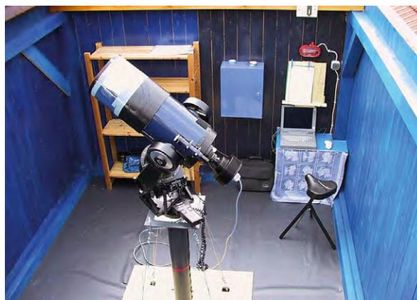
Abb. 2: Blick in den Beobachtungsraum. 8" Meade LX50 auf der Stahlsäule. Auf dem kleinen Tisch steht der Laptop zum Steuern der CCD-Kamera ST-6. Darüber sieht man eine Dokumentenablage und die Rotlichtlampe.
