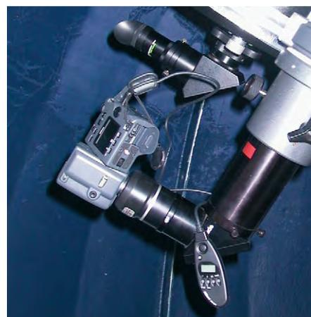
Abb. 1: Moderne Digitalkameras für die Deep-Sky-Fotografie. Canon D60 (links) und Nikon Coolpix 995 am Fernrohr (rechts).
