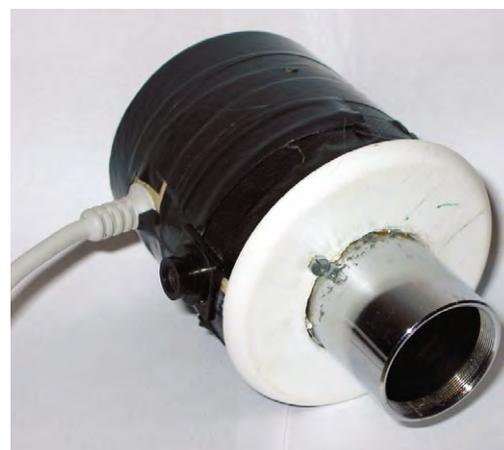
Abb. 2: Teleskopadapter und Kamergehäuse in der Eigenbaulösung. [Dirk van Uden]
