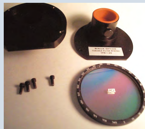
Das variable Filtersystem in seine Einzelteile zerlegt. Deutlich zu sehen ist die Scheibe mit den unterschiedlichen Filterbereichen.
