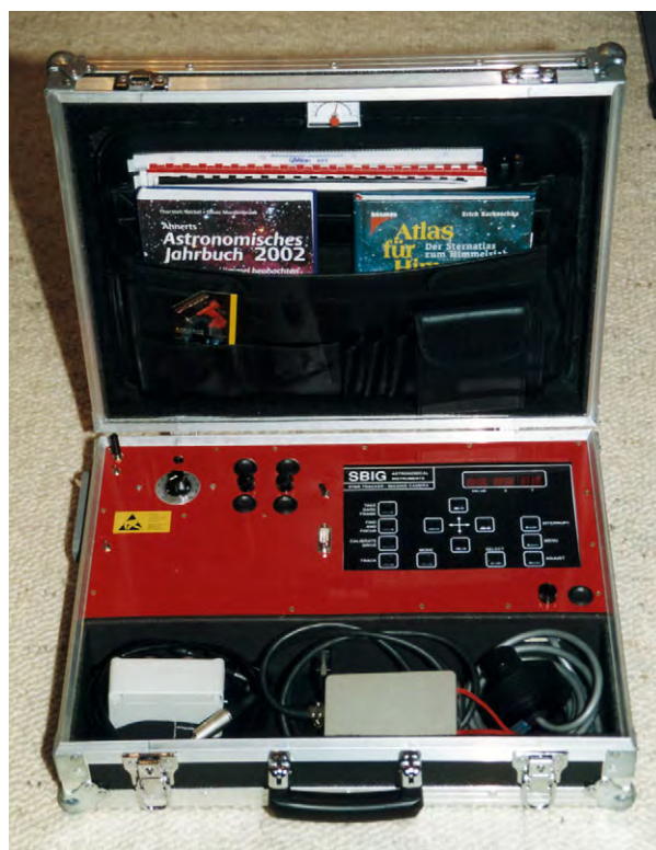
Abb. 4: Der selbstgebaute Teleskopsteuerungskoffer enthält die FS2-Steuerung und die Geräte für einen Autoguider und eine beheizte Taukappe.
