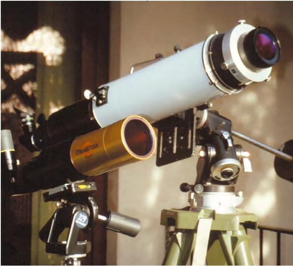
Abb. 1: NearStar-Fernrohr (links) und ASP60 am 100/800-Refraktor (rechts) im Einsatz.
