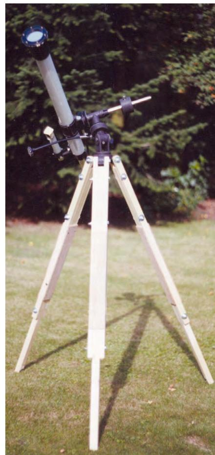
Abb. 1: Ein einfacher 60mm-Refraktor mit Glas-Sonnenfilter ist bestens zu gefahrlosen Sonnenbeobachtung geeignet. Das Sucherteleskop ist abgedeckt. [Foto: Peter Simmen]
