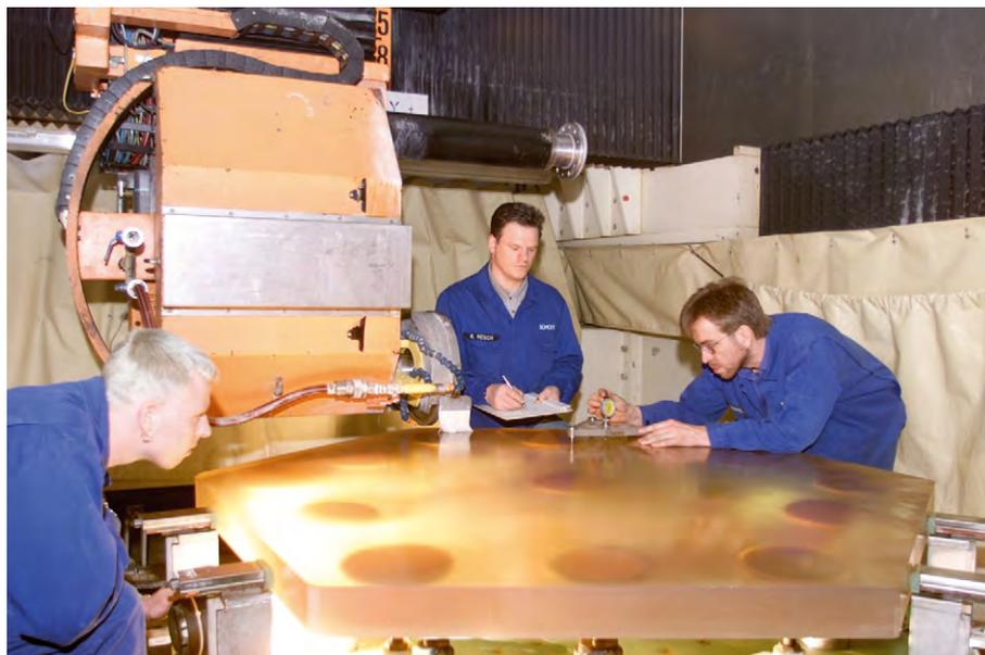
Abb. 2: Prüfung eines Spiegelsegments bei Schott vor der Auslieferung nach Paris. [Foto: Schott]
