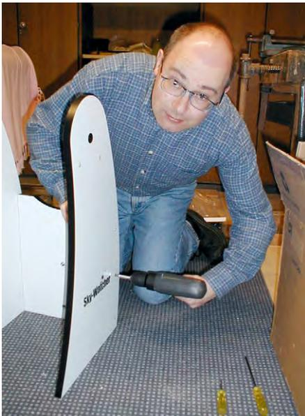
Abb. 2: Ein Akkuschaubenzieher erleichtert den Zusammenbau ungemein, verglichen mit dem beigelegten Werkzeug (unten rechts).
