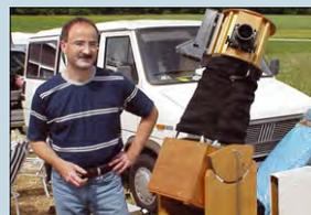
4. Preis: Bernhard Englert mit einem 6"-Dobson f/4,5, Spiegel selbstgeschliffen, die Reibung zwischen Höhenrädern und Rocker-Box wird mit Federn verstärkt.
