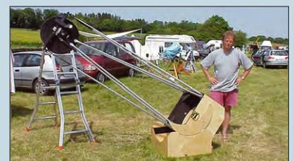
2. Preis: Rüdiger Heins mit einem 18"-Dobson f/5,5, selbstgeschliffener Spiegel, sehr dünn, auf »Knallfolie« gelagert, als Gitterstreben wurden Zeltstangen verwendet.
