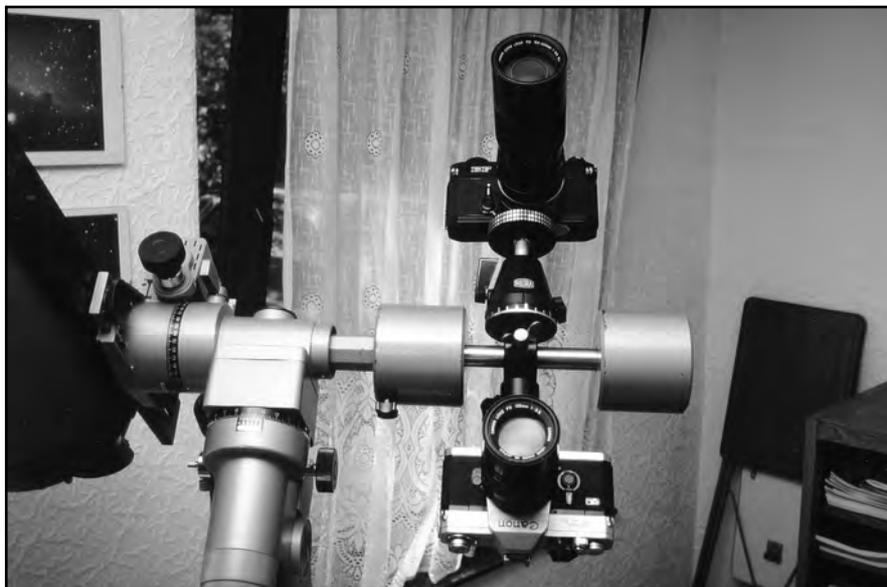
Abb. 1: Auf Gegengewichtsstange montierte Kameras
