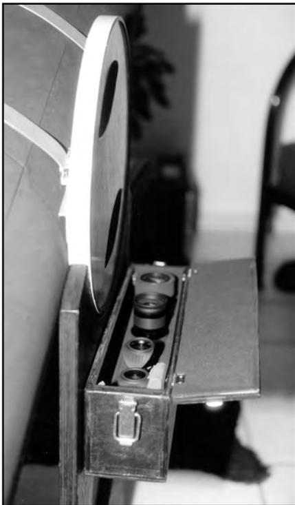
Um die Rockerbox so klein wie möglich zu halten, mußten die Höhenräder so eng wie möglich am Tubus anliegen. Auf die Innenseiten der Höhenräder wurden je 2 L-Profile aus Alu vom Baumarkt verklebt und verschraubt. An diesen wurden 4 Alu-Flachschielen justierbar geschraubt, die den Tubus umspannen und tragen. Jedes Höhenrad liegt an 5 Punkten am Tubus an. Die Konstruktion ist sehr stabil. Nur die Justierung auf Parallelität war nicht ganz einfach.
