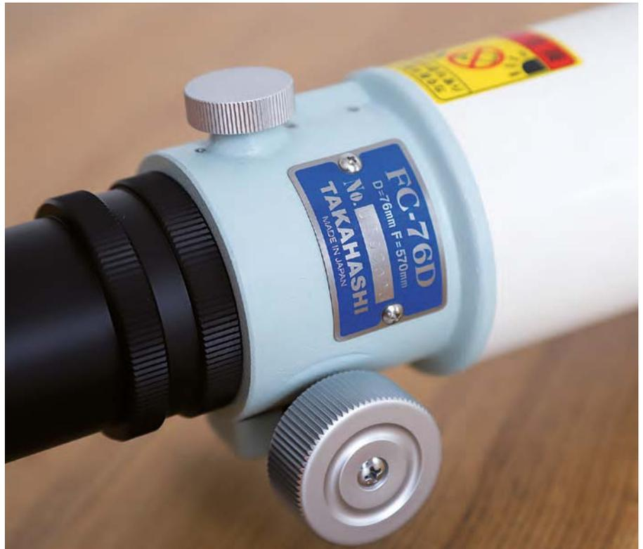
▲ Abb. 4: Der Auszug des Takahashi FC-76DCU kann nach Fokussierung mittels der oben angeordneten Schraube fixiert werden, über eine 1:10-Untersetzung verfügt der FC-76DCU jedoch leider nicht.
