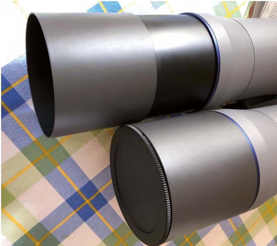
▲ Abb. 6: Die ausziehbaren Tauschutzkappen helfen besonders im Frühling und Herbst bei schnellen Temperaturwechseln.
