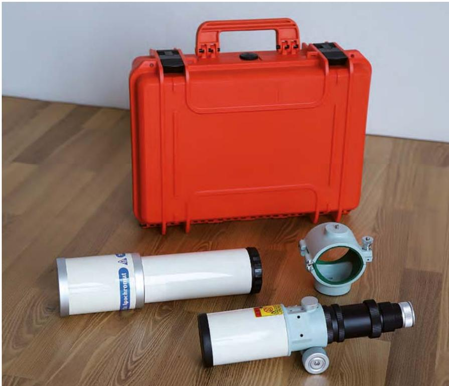
▲ Abb. 2: Flugkabinen-tauglich ist der Schutzkoffer, der das FC-76DCU in zerlegtem Zustand zusammen mit dem notwendigen Zubehör aufnimmt. Montiert am hinteren Teleskoptubus sind die der Optik beiliegenden Zubehörteile, die hier mit der Anschlussmöglichkeit für 1,25-Zoll Okulare enden.
