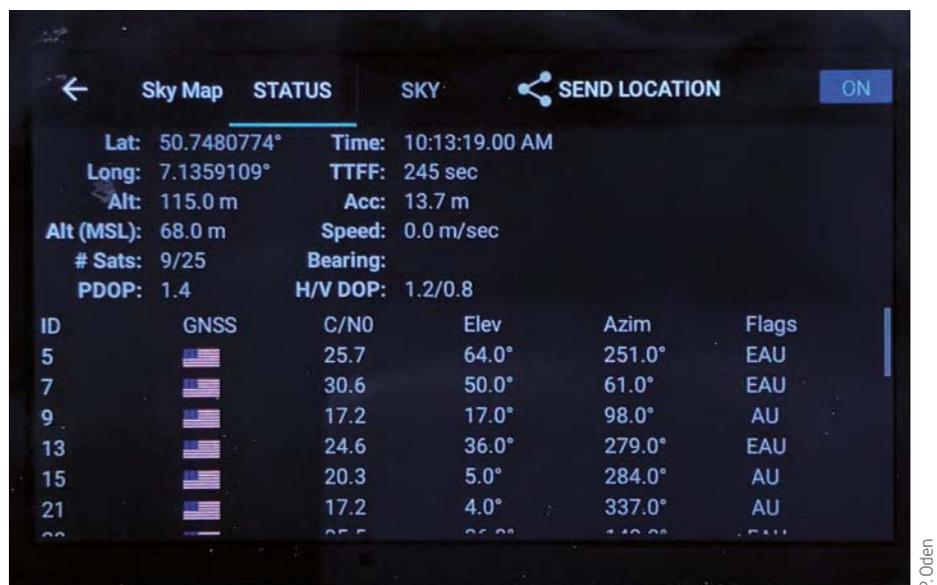
▲ Abb. 5: Die Empfangsdaten von GPS- und GNSS-Satelliten lassen sich auf dem Bildschirm anzeigen.
