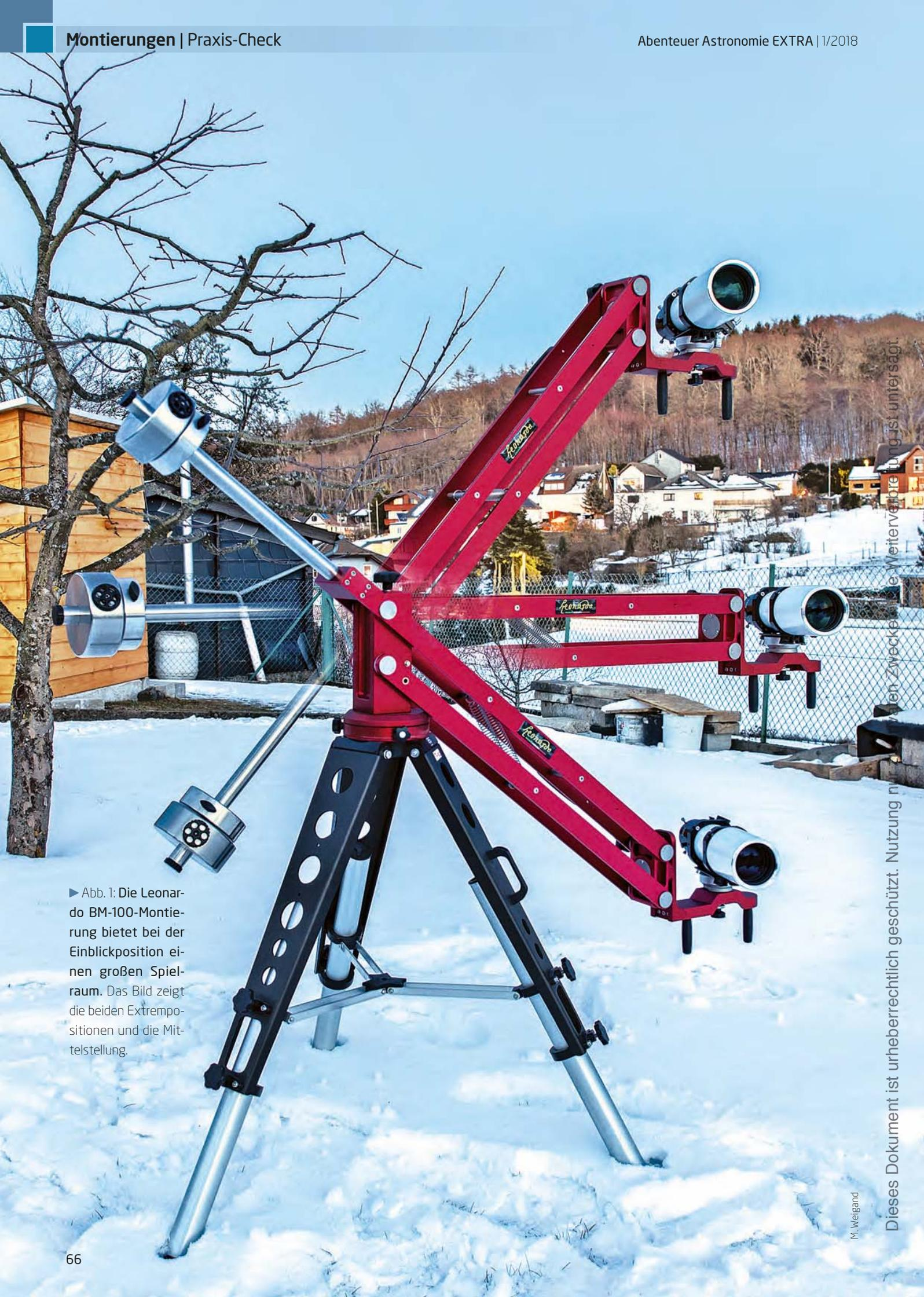
► Abb. 1: Die Leonardo BM-100-Montierung bietet bei der Einblickposition einen großen Spielraum. Das Bild zeigt die beiden Extrempositionen und die Mittelstellung.
