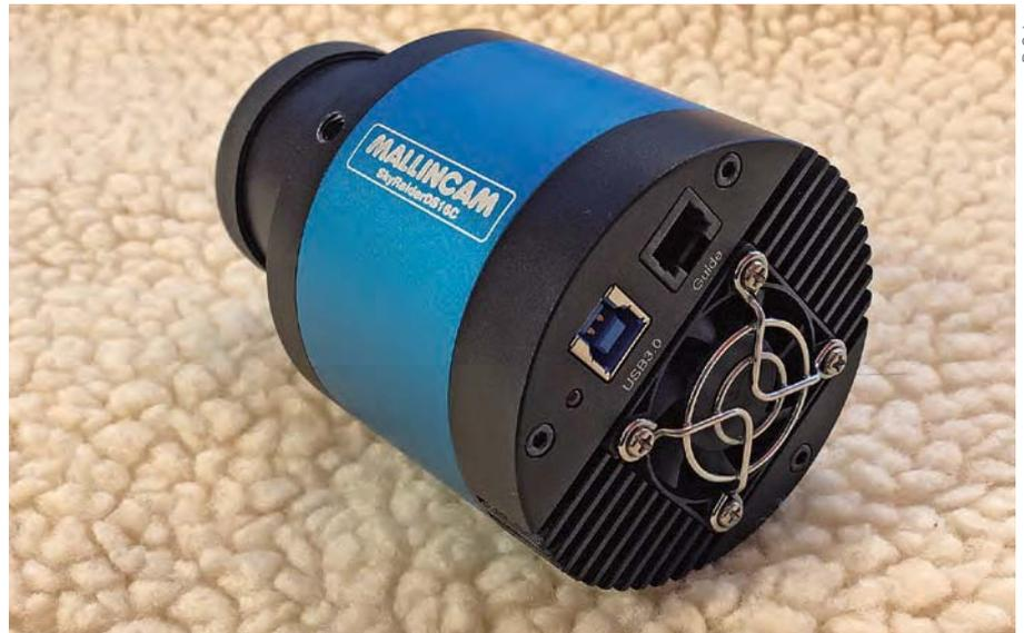
▲ Abb. 2: Die DS16C aus der Nähe mit USB 3.0-Anschluss, Guiding-Port und Ventilator.
