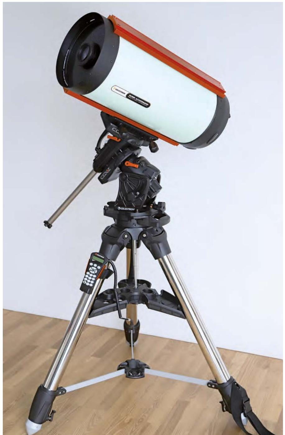
▲ Abb. 1: Das 1100 RASA ist zusammen mit der CGX-L-Montierung schon rein optisch eine beeindruckende Teleskop-Montierungs-Kombination (hier noch ohne angeschlossene Kamera und ohne Gegengewichte).
