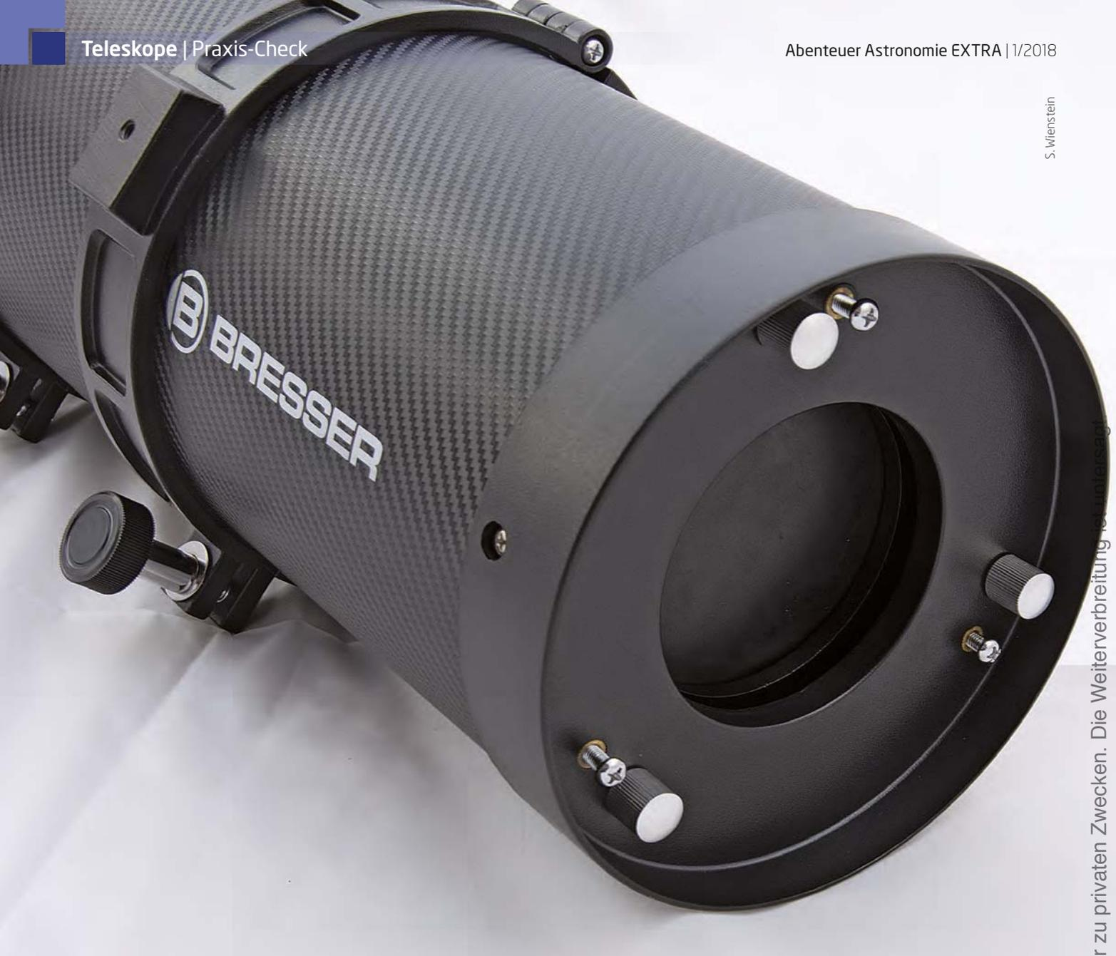
▲ Abb. 3: Die Tubusrückwand, an der sich auch die Justageschrauben des Hauptspiegels abstützen, ist aus Kunststoff. Darunter liegt aber eine Spiegelhalterung aus Metall.
