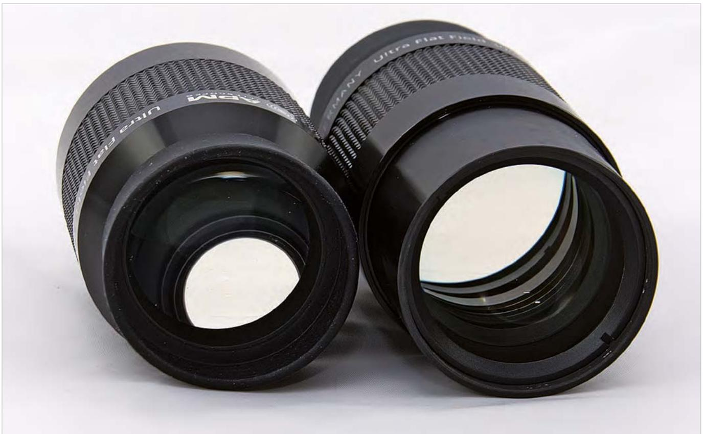
▲ Abb. 4: Aus beiden Richtungen ins Okular geblitzt zeigt sich eine gute Schwärzung, je nach Blickwinkel glänzt aber das Filtergewinde in der Steckhülse.
