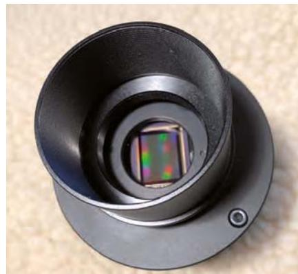
▲ Abb. 3: Der große Aufnahmechip der MallinCam DS16C.
