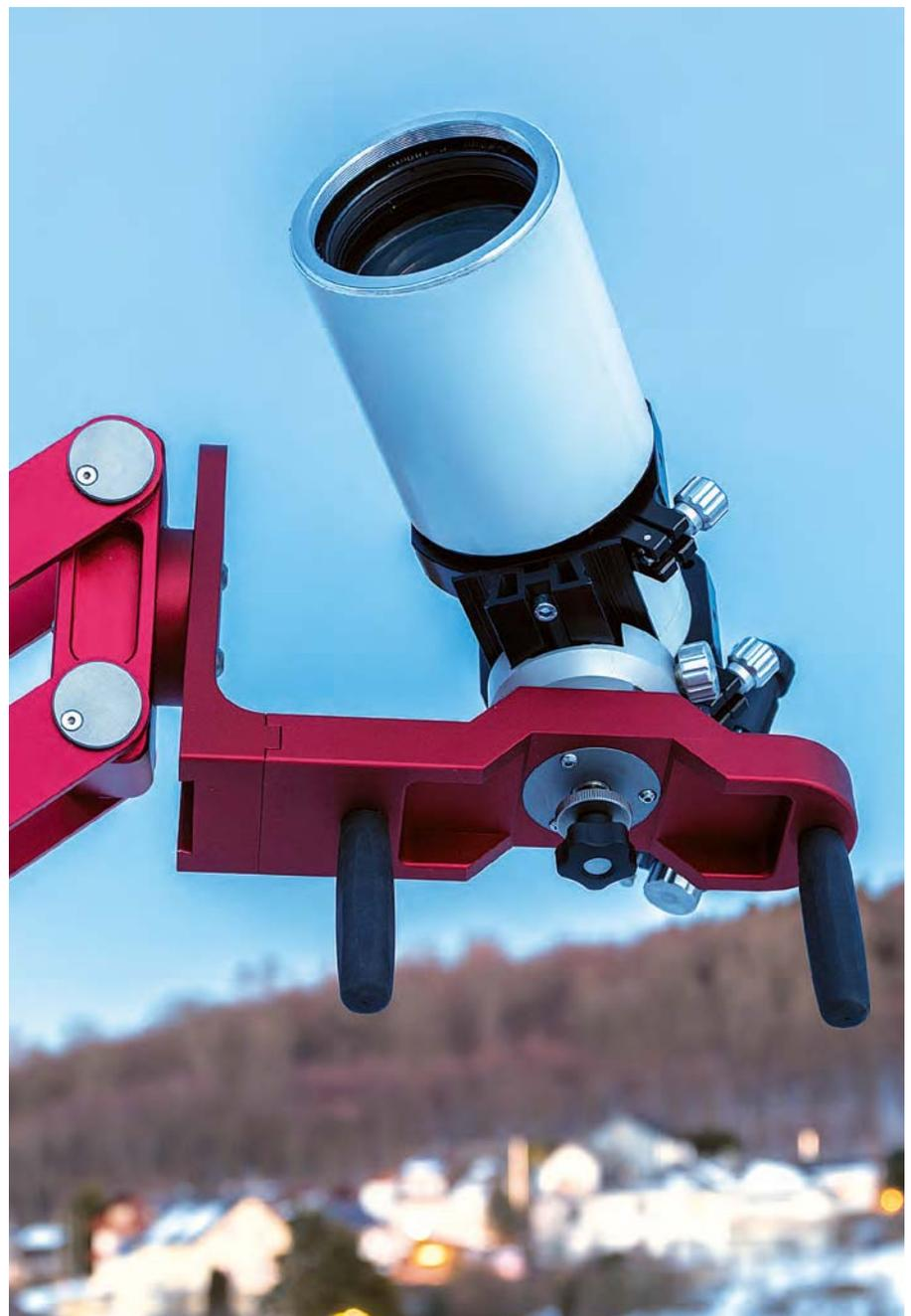
▲ Abb. 2: Die Montageplattform am oberen Ende der Montierung. Hier ist eine Prismenklemme nach 44mm-Schienenstandard adaptiert. Mit den Verstellmöglichkeiten in Höhe und Azimut können Objekte über längere Zeit verfolgt werden.
