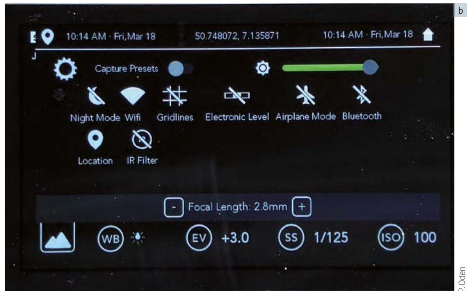
▲ Abb. 4: Der Startbildschirm der Tiny1. Die Einstellungen der Kamera werden fast ausschließlich über den Touchscreen vorgenommen (a). Zusätzliche Einstellungen sind mit einem Wisch verfügbar (b).
