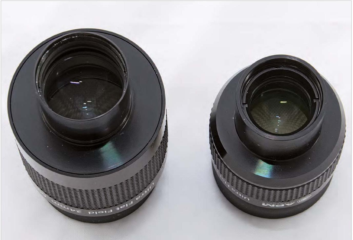
▲ Abb. 2: Besonders beim 25mm (links) ist die Schwärzung des Filtergewindes nicht gelungen.
