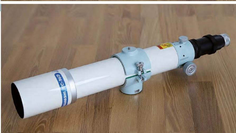
▲ Abb. 3: Beide Teleskopteile lassen sich mit wenigen Handgriffen über das zentral angeordnete Gewinde miteinander verbinden (a), das dann anschließend von der Rohrschelle verdeckt wird, wenn das Teleskop zum Einsatz komplett zusammengebaut ist (b).
