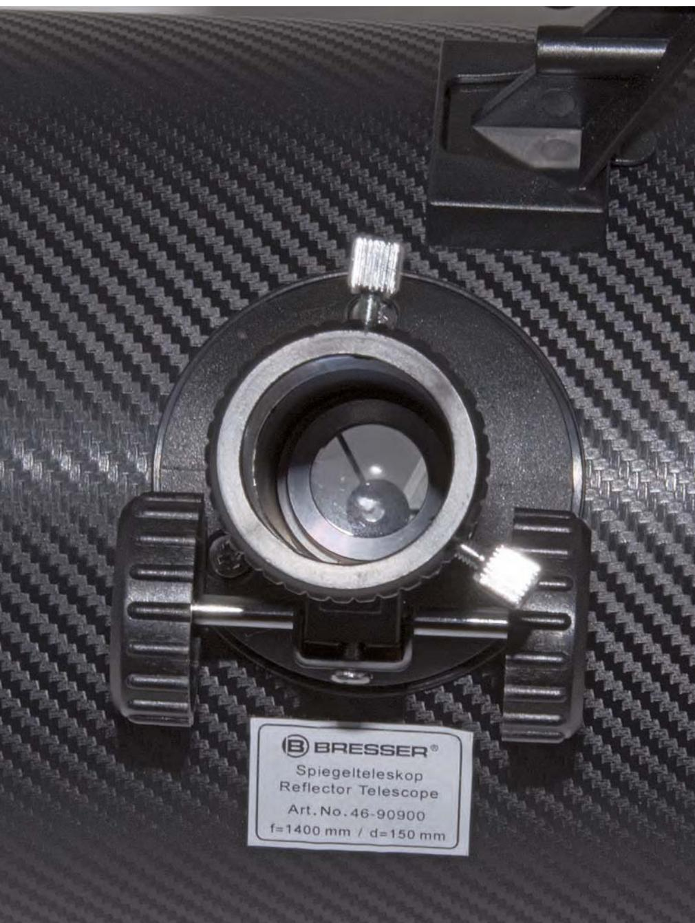
► Abb. 5: Beim Cat-Newton ist am unteren Ende des Okularauszugs ein Korrektor eingesetzt, der die Abbildungsfehler des sphärischen Hauptspiegels beheben soll.
