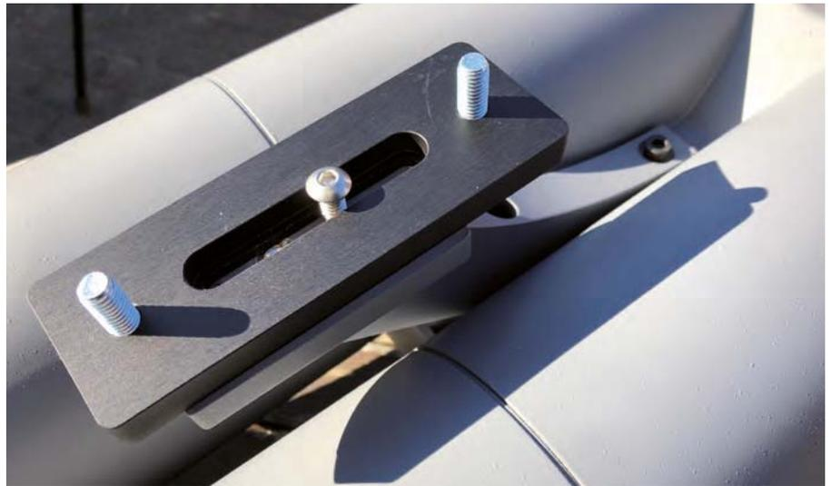
▲ Abb. 2: Die Adapterplatte, mit der das Großfernglas auf der Gabelmontierung befestigt werden kann.
