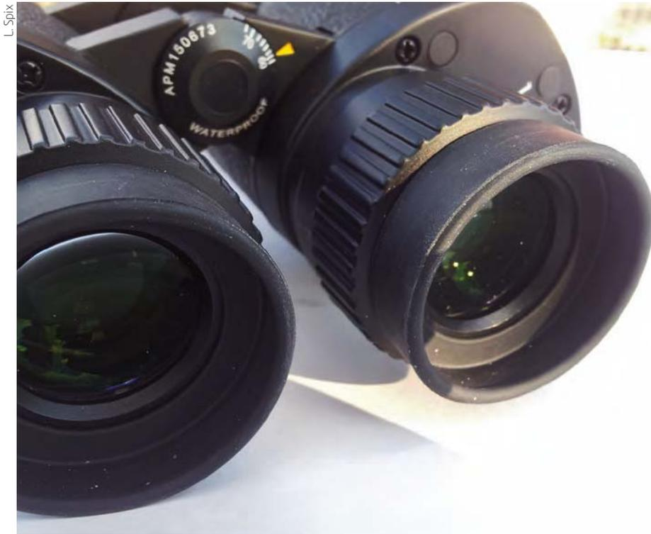
▲ Abb. 2: Die großen Okularlinsen ermöglichen mit 20mm Austrittspupillenabstand einen komfortablen Einblick.
