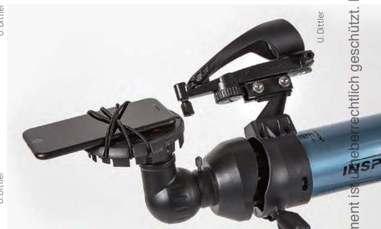
▲ Abb. 4: Der Objektivdeckel des Teleskops kann als Smartphone-Halterung verwendet werden: er kann hierzu mit der Innenseite auf das Okular gesteckt werden, so dass ein beliebiges Smartphone mittels der Gummibänder auf der Oberseite so positioniert werden kann, dass die Smartphone-Kamera direkt über dem Okular zu liegen kommt.
