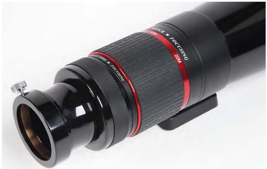
▲ Abb. 3: Der zweiteilige und leichtgängige Helikal-Fokussierer erleichtert die exakte Fokussierung: der breite gummierte Ring dient der groben Fokussierung, während der schmalere Fokussiering 1:10 untersetzt ist und so eine exakte Feinfokussierung ermöglicht.
