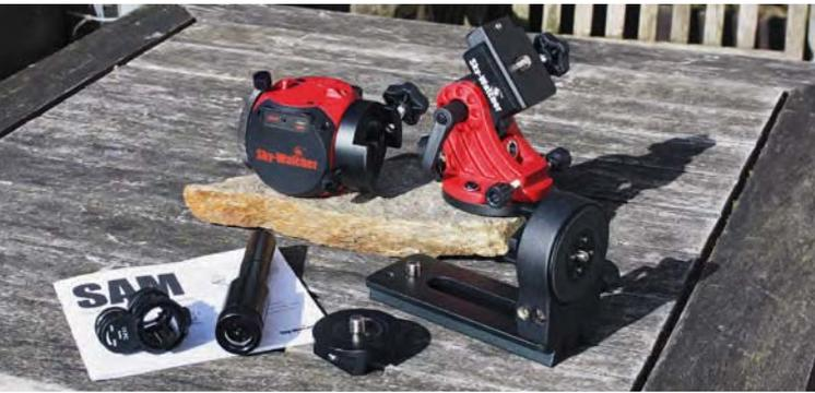
◀ Abb. 2: Das SAM-Set mit Montierungsblock, Polhöhenwiege, Polsucher, Deklinationseinheit und Kugelpf-Montageplatte.
