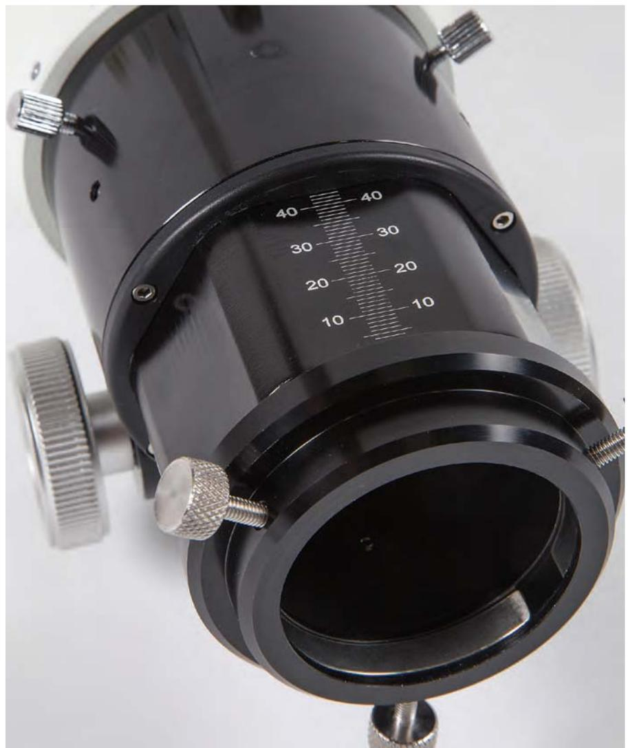
▲ Abb. 3: Der wertige Metall-Auszug verfügt über 40mm Fokusweg und eine entsprechende Millimeterskala, jedoch keinen unteretzten Feinfokus. Hier ist der 2-Zoll-Okularadapter am Ende des Auszugs montiert, um beispielsweise eine Kamera aufnehmen zu können.
