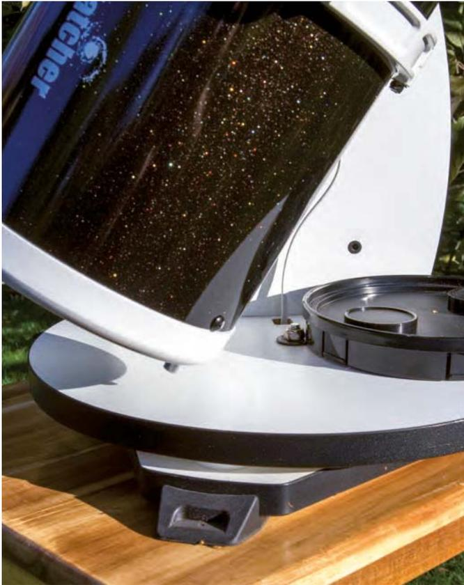
▲ Abb. 2: Mit dem Rohr in der Balance setzen die Justagerändel schon weit vor der Zenitstellung auf.
