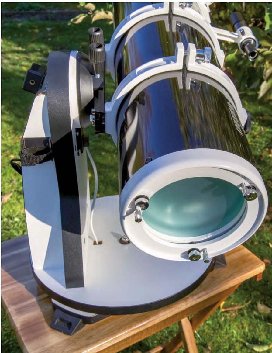
▲ Abb. 5: Die offene Spiegelrückseite fördert die Auskühlung, Rändel erlauben die Feinjustage ohne Werkzeug.
