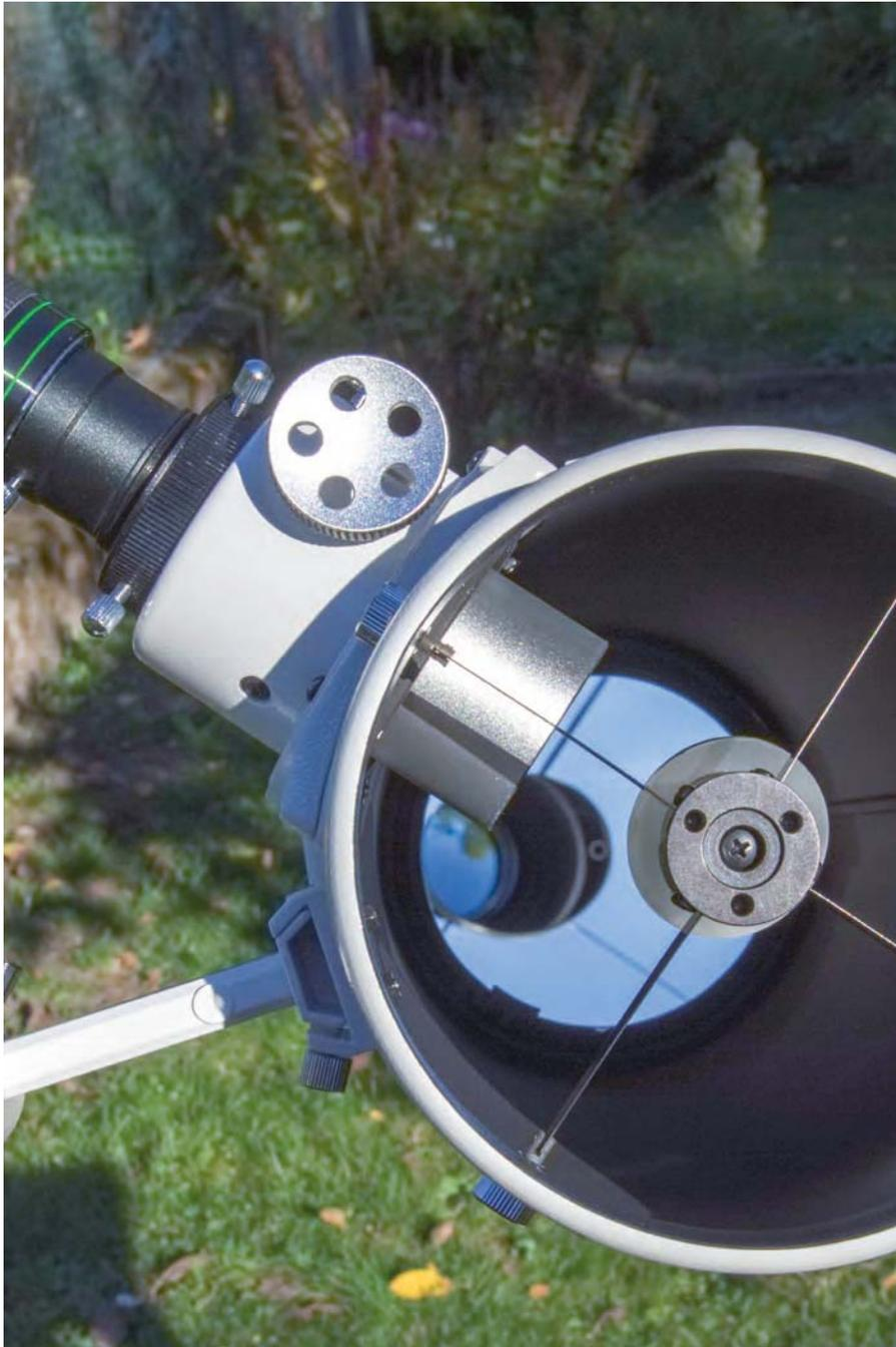
▲ Abb. 6: Der Okularauszug ragt eingefahren massiv in den Strahlengang.
