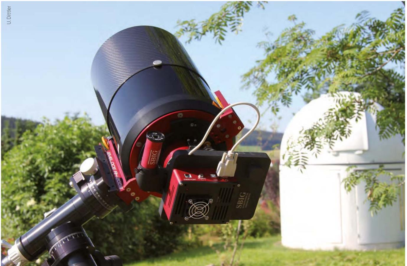
▲ Abb. 2: Für den fotografischen Nachweis eines Exoplaneten eignen sich gekühlte CCD-Kameras an Schmidt-Cassegrain-Teleskopen mit 200mm Öffnung sehr gut; wobei der Nachweis auch mit anderen Teleskoptypen möglich ist – es gibt auch erfolgreiche Exoplanetennachweise, die mit 60mm-Refraktoren gelungen sind.
