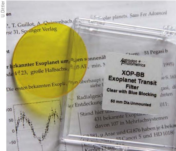
▲ Abb. 4: Da sich die Beobachtung eines Transits über mehrere Stunden hinziehen kann und sich der Stand des beobachteten Sterns über dem Horizont deutlich ändert, kann es hilfreich sein, einen Exoplaneten-Filter einzusetzen, der den Einfluss des Horizontdunstes auf die aufgezeichneten Bilder reduziert.
