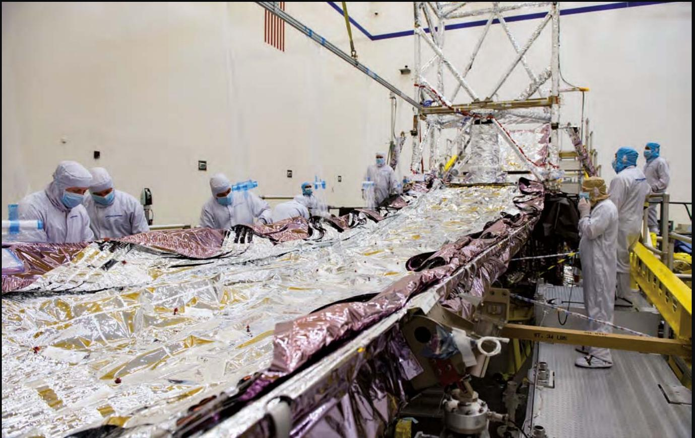
▲ Abb. 2: Techniker beim Überprüfen des gewaltigen Sonnenschutzschilds des James Webb Space Telescope nach einem Test. Der Sonnenschutz ist eine missionskritische Komponente für das Weltraumteleskop.
