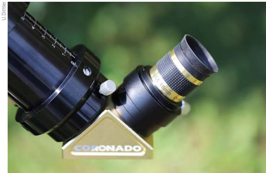
▲ Abb. 4: Zum Lieferumfang des »SolarMax III 70mm« gehört ein 18mm-Okular der Cemax-Reihe von Coronado.
