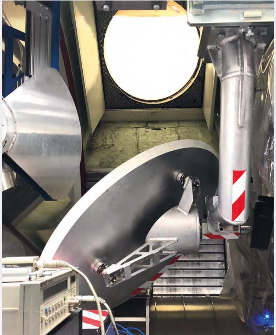
▲ Abb.4: Schwenkbare Spiegel erlauben die schnelle Umschaltung auf unterschiedliche Empfangsgeräte.
