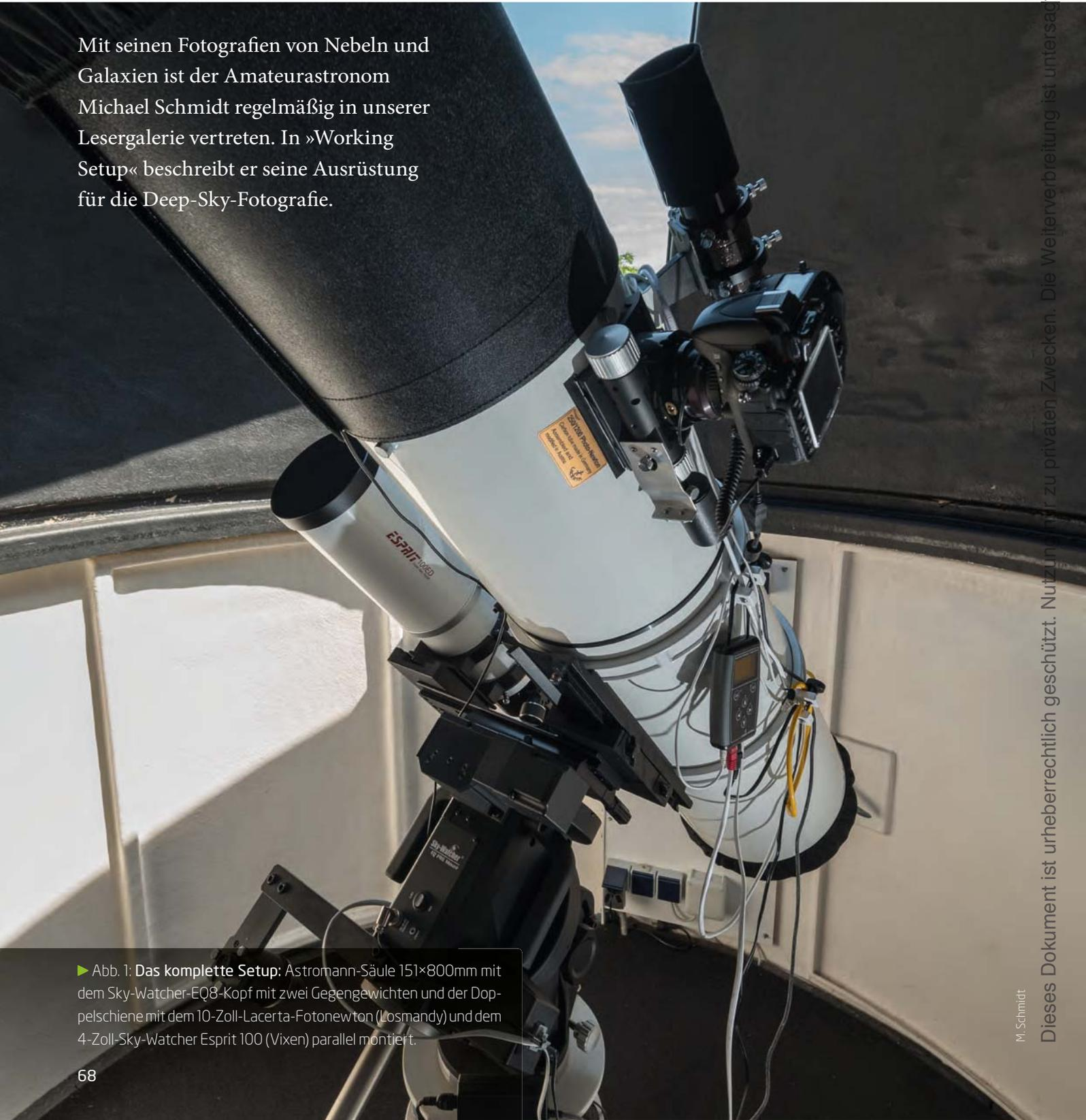
► Abb. 1: Das komplette Setup: Astromann-Säule 151×800mm mit dem Sky-Watcher-EQ8-Kopf mit zwei Gegengewichten und der Doppelschiene mit dem 10-Zoll-Lacerta-Fotonewton (Losmandy) und dem 4-Zoll-Sky-Watcher Esprit 100 (Vixen) parallel montiert.
