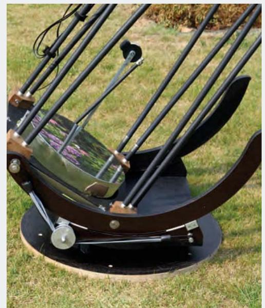
▲ Abb. 1: Expander mit einzeln einhängbaren Federschnüren eignen sich hervorragend, um die Federstärke anzupassen.
