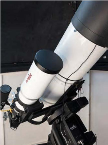
▲ Abb. 2: Die EQ8-Montierung mit Doppelschiene.
