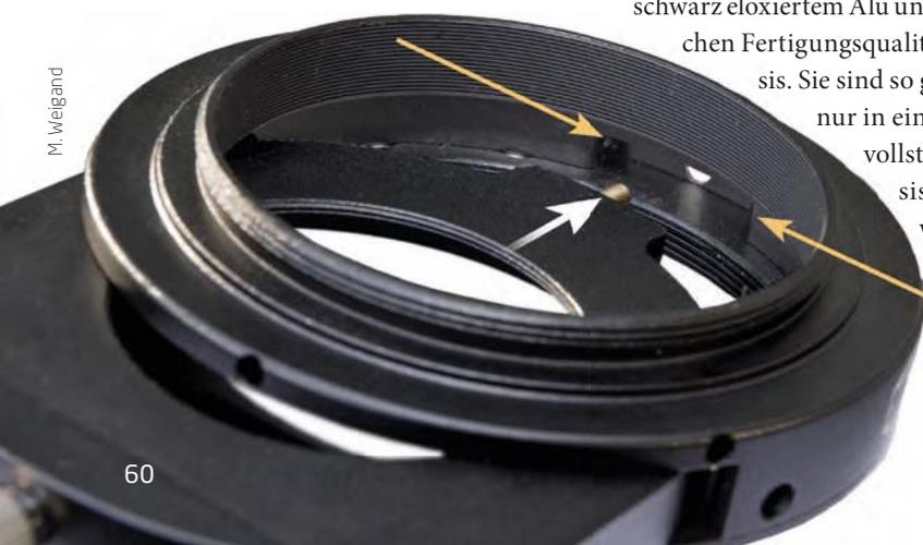
▲ Abb. 2: Die Passfeder mit Passtift an der Filterschublade (weißer Pfeil) und die seitlichen gefederten Druckstücke in der UFC-Basis (gelbe Pfeile) sorgen für eine reproduzierbare Positionierung des Filters.
