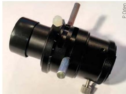
▲ Abb. 5: Ein ADC (Atmospheric Dispersion Corrector) mit seinen diversen Einstellmöglichkeiten.
