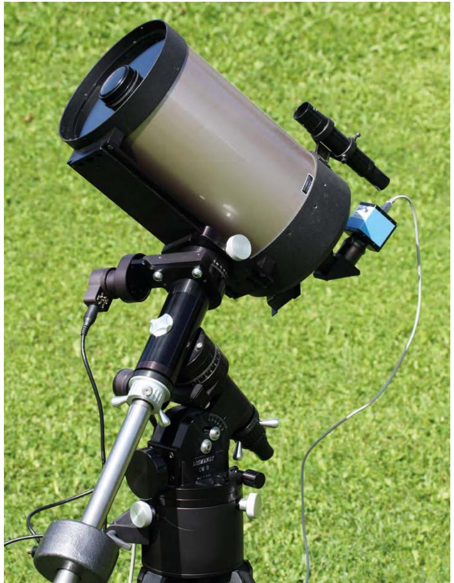
▲ Abb. 2: Kompakte, langbrennweitige Teleskope wie das hier abgebildete Schmidt-Cassegrain-Teleskop eignen sich hervorragend für die Planetenfotografie. Die motorgetriebene deutsche Montierung ermöglicht eine exakte Nachführung der optischen Einheit und so auch längere Belichtungssequenzen mit der angeschlossenen CCD-Kamera.
