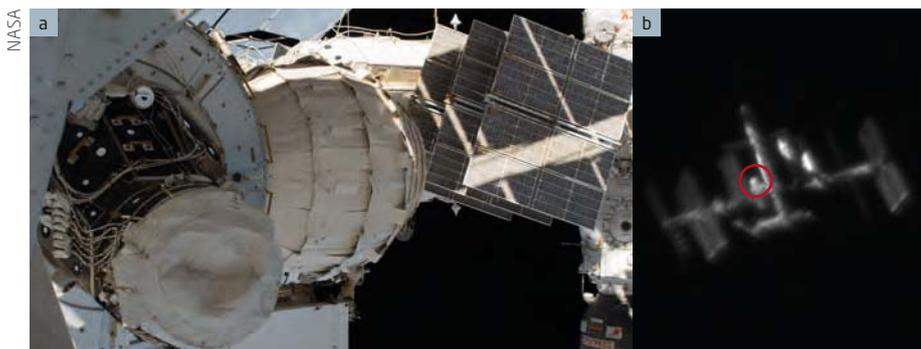
▲ Abb. 8: Auch Veränderungen auf der ISS lassen sich vom Boden dokumentieren, wie etwa das im April 2016 zur ISS gebrachte und montierte aufblasbare Bigelow Expandable Activity Module (BEAM). Das Modul (a, eine Aufnahme von der ISS aus) ist auch von der Erde aus zu sehen (b).
