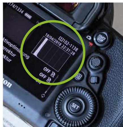
▲ Abb. 3: Hilfreich für das Finden der richtigen Belichtungszeit ist ein Blick auf das Histogramm. Dort fällt der Himmel typischerweise als markantes Maximum auf, das sich bei etwa 10% bis 20% des Wertebereichs befinden sollte.
