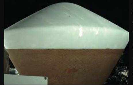
▲ Abb. 7: Die Proben-Kapsel von OSIRIS-REx, gesehen im März 2017 von einer der technischen Kameras an Bord. Der kleine dunkle Fleck, 2 mm groß, war vor dem Start nicht da: Hier ist unterwegs ein winziges Teilchen eingeschlagen.
