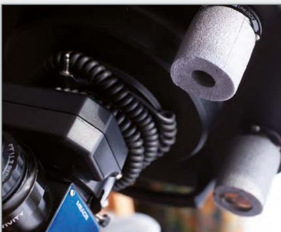
▲ Abb. 1: Schaumstoffhülsen sorgen für den perfekten Griff am Teleskop – auch bei Kälte und Nässe.
