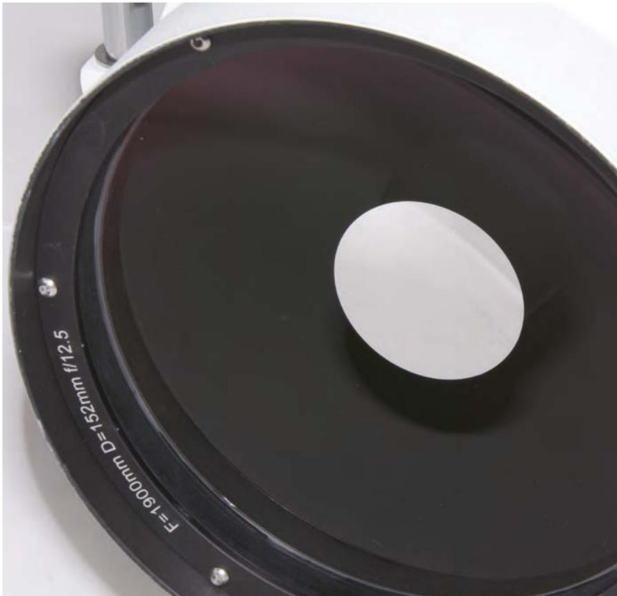
▲ Abb. 3: Bei genauem Hinsehen bemerkt man, dass die verspiegelte Fläche deutlich größer ist als das aufgeklebte Blendrohr.
