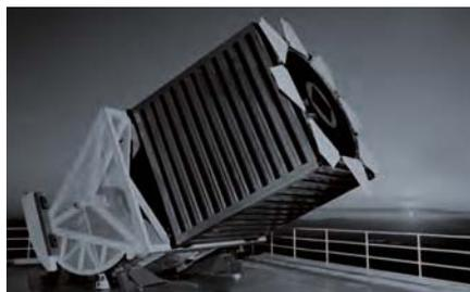
► Abb. 2: Das relativ kleine, robotische 2,5-Meter-Teleskop des Sloan Digital Sky Surveys (SDSS) am Apache-Point-Observatorium in New Mexico, USA.
