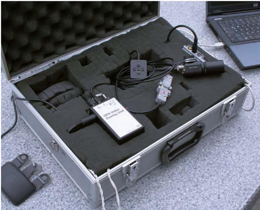
▲ Abb. 2: Die typische Ausrüstung eines Beobachters von Sternbedeckungen besteht aus einem GPS-Empfänger, verbunden mit einem Video Time Inserter, einer analogen, hochempfindlichen SW-Kamera und einem Frame Grabber, der an einen Computer angeschlossen ist (von links).
