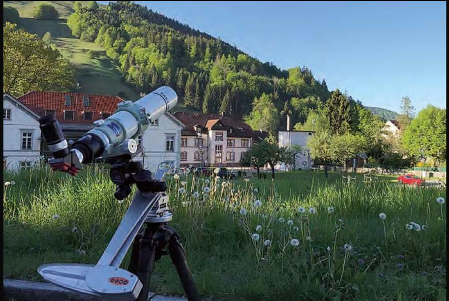
▲ Abb. 2: Das für die Erstellung von Abbildung 1 genutzte Equipment: ein Takahashi FS-60Q mit einer Brennweite von 600mm auf einer AstroTrack-Reisemontierung, als Kamera wurde eine Point-Grey Grasshopper3-U3-28S5M verwendet. Zur exakten Ausrichtung ist auf dem Bild noch ein Okular an der späteren Position der Kamera ins Teleskop eingesetzt.
