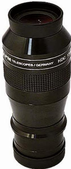
Telescopes zugeordnet. Die Ausstattung der großen Okulare mit umklappbarer Gummiaugenmuschel und Gummiarmierung ist bei beiden Labels vergleichbar. Unter der abnehmbaren Augenmuschel besitzt das Okular ein Anschlussgewinde M44,5x0,75 zur Adaption von Kameras. Teleskopseitig lässt sich die 1,25 Zoll Steckhülse mit einem geschraubten Adapterring auf 2-Zoll-Steckmaß erweitern. Für beide Steckdurchmesser steht ein Filtergewinde zur Ver-
