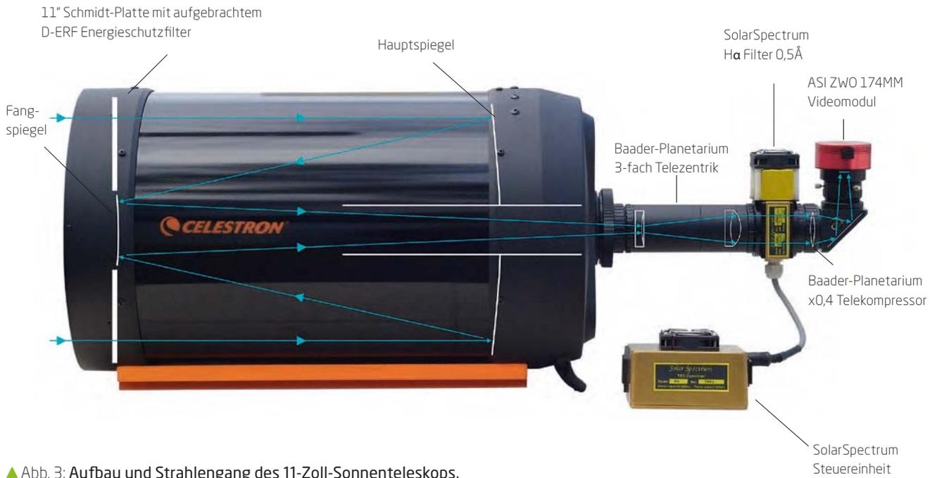
▲ Abb. 3: Aufbau und Strahlengang des 11-Zoll-Sonnenteleskops. Der Strahlengang durch das Filter verläuft weitestgehend parallel.
