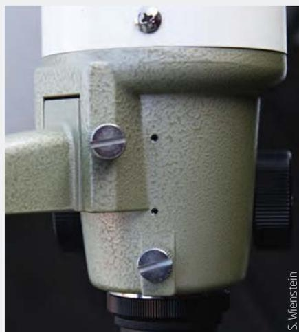
▲ Abb. 2: Leicht zu übersehen – dieser Okularauszug kann mit kleinen Madenschrauben auf die richtige Spur gebracht werden.
