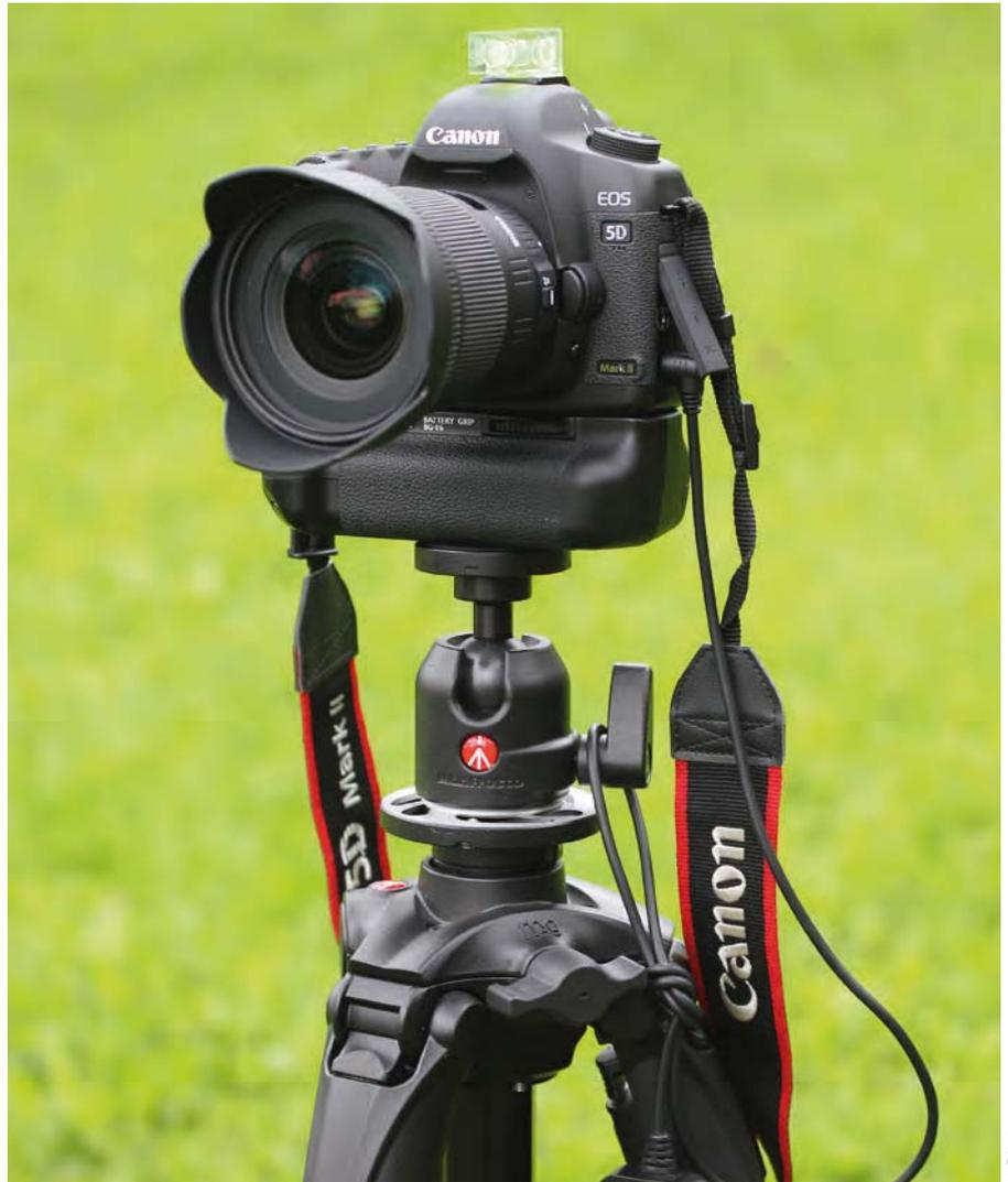
▲ Abb. 2: Für den Einstieg in die Milchstraßenfotografie reicht eine DSLR (hier wird eine Vollformat-DSLR verwendet, um einen größeren Ausschnitt des Himmels abbilden zu können) mit lichtstarkem Objektiv auf einem stabilen Stativ. Ein Fernauslöser ermöglicht ein erschütterungsfreies Auslösen der Kamera.
