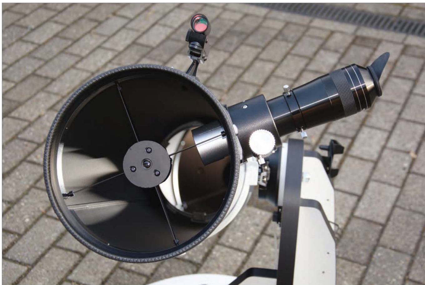
▲ Abb. 4: Blick in den Tubus mit angenehm schlanker Fangspiegelhalterung. Der Okularauszug kann in den Strahlengang ragen.
