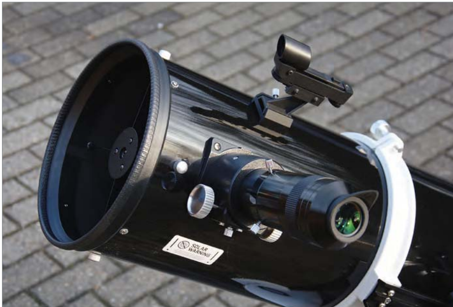
▲ Abb. 2: Der Okularauszug trägt auch schwere Okulare mit 2-Zoll-Einsteckdurchmesser.
