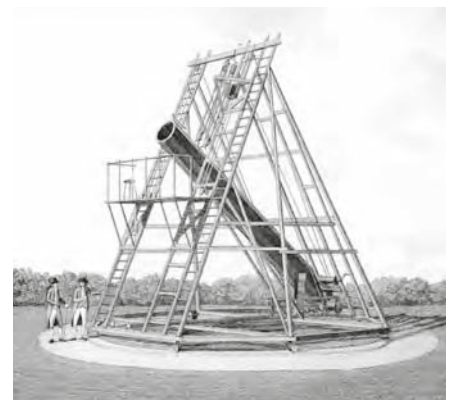
▲ Abb. 4: Herschels 18,7-Zoll-Teleskop mit 6,1m Brennweite.
