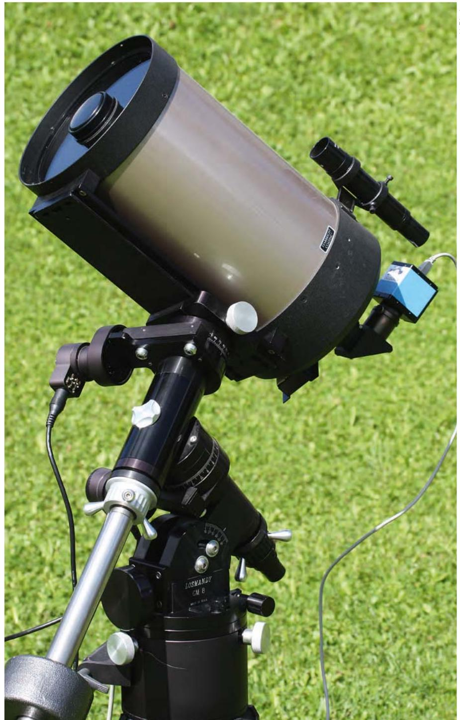
▲ Abb. 2: Zum Einstieg in die Fotografie des Mondes kommt oft ein Schmidt-Cassegrain-Teleskop auf einer motorisch nachgeführten Montierung zum Einsatz (hier ein SCT vom Typ Celestron C8 auf einer Losmandy GM-8-Montierung). Als Aufnahmegerät dient eine ungekühlte CCD-Kamera von The Imaging Source.
