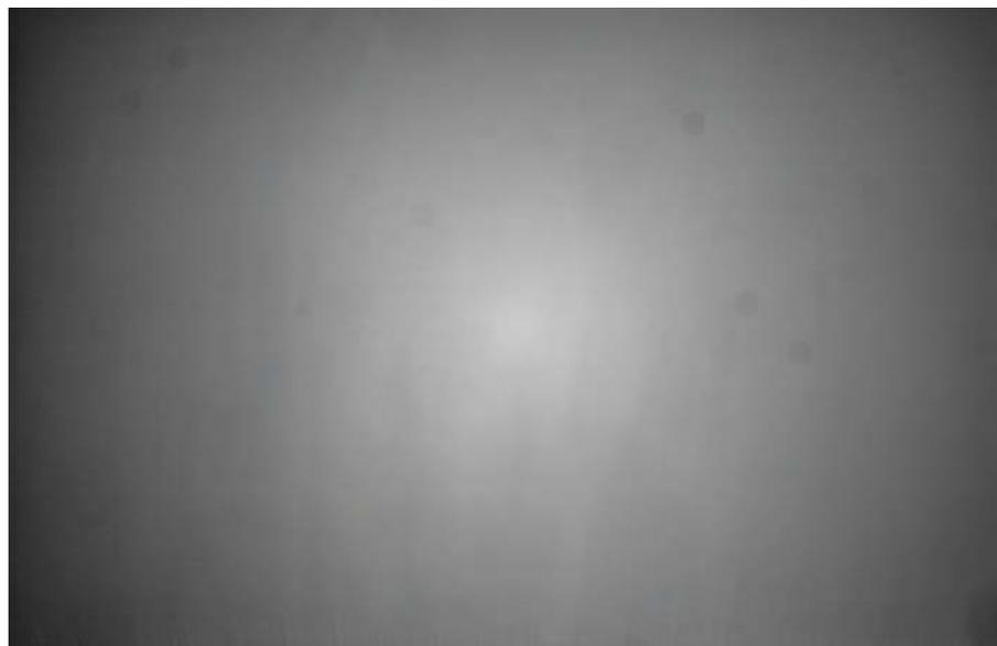
◀ Abb. 3: Ein typisches Flatfield-Bild mit Vignettierung des Teleskops und runden Staubflecken.
