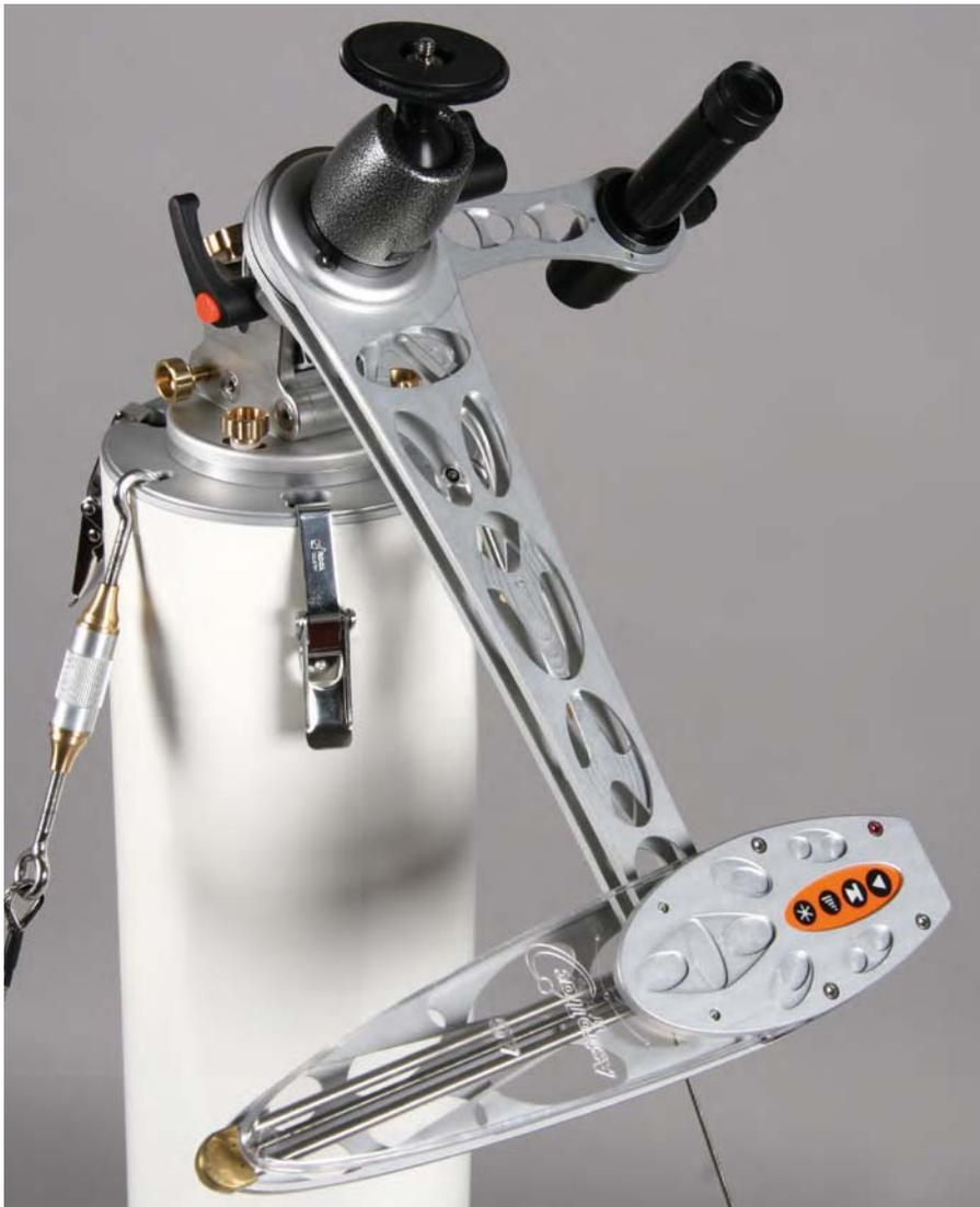
◀ Abb. 4: Parallaktische Montierungen haben sich auch als Reisemontierungen bewährt. Diese Montierung vom Typ AstroTrack führt den montierten Kugelkopf batteriebetrieben bis zu zwei Stunden nach, um so auch am Urlaubsort Astrofotografie zu ermöglichen. Deutlich ist rechts das Polsucherfernrohr zu erkennen, dass die Ausrichtung der Montierung auf den Himmelspol vereinfacht.
