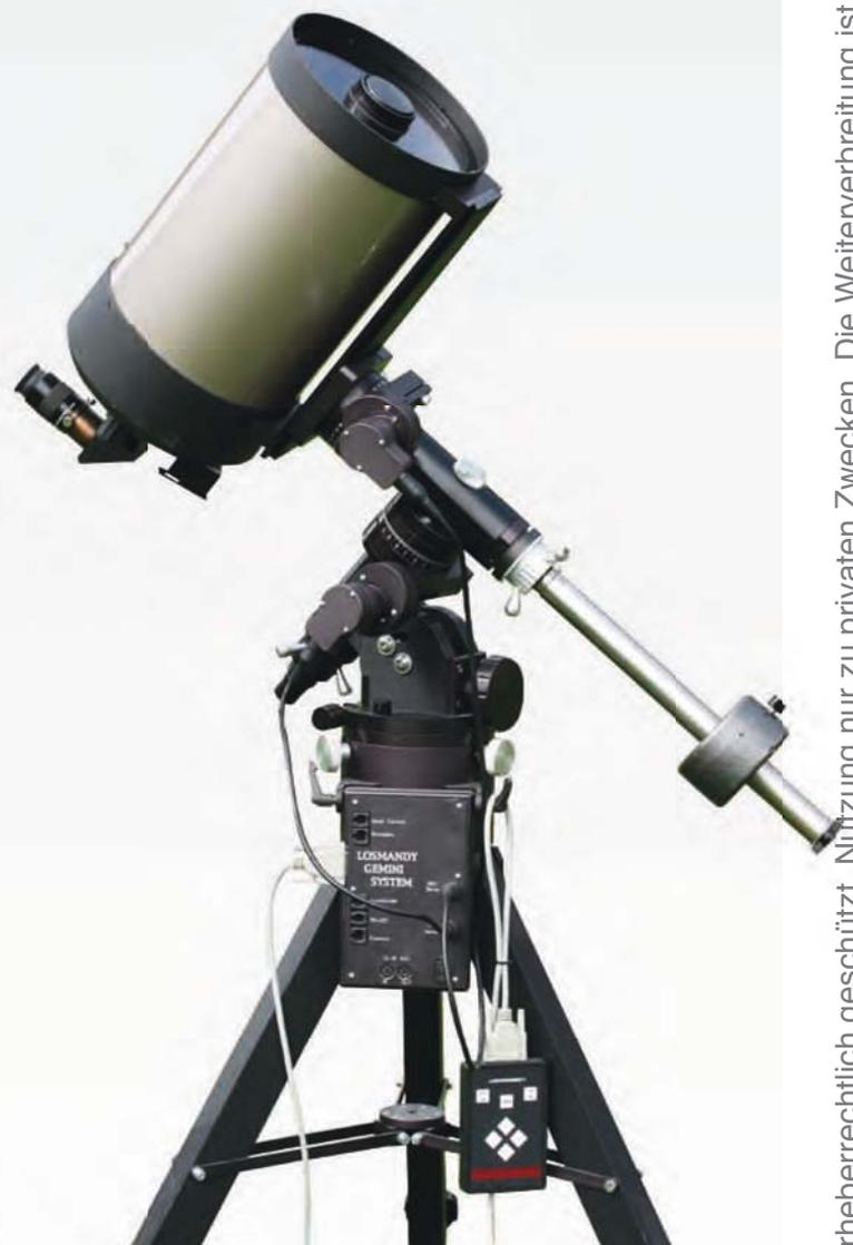
▲ Abb. 3: Zur Beobachtung von Mond und Planeten kommt hier ein Schmidt-Cassegrain-Teleskop auf einer deutschen Montierung vom Typ Losmandy GM-8 zum Einsatz. Die Montierung ist deutlich massiver und damit tragfähiger als die in Abb. 2 gezeigte leichte Montierung. Beide Achsen dieser Montierung sind motorisch betrieben und zudem verfügt die Montierung über eine GoTo-Funktionalität, die es ermöglicht, zahlreiche Himmelsobjekte computergesteuert anzufahren.
