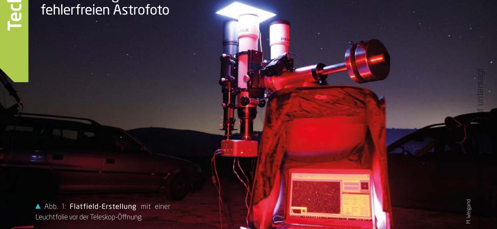
▲ Abb. 1: Flatfield-Erstellung mit einer Leuchtfolie vor der Teleskop-Öffnung.
